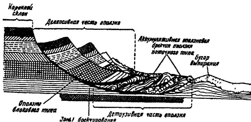
Рис. 8.42. Строение оползня и наземнооползневые складки, сосредоточенные в детрузивной части оползня (выделено скобкой, по Г.П. Горшкову и Якушевой)
