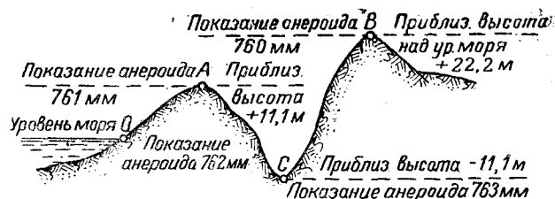
Фиг. 185. Результаты барометрического нивелирования.
