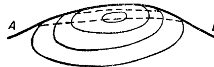
Фиг. 227. Изображение рельефа местности (крутизны склона) методами изогипс при построении блок-диаграммы.
