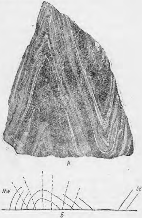
Рис. 154. А — складка в полосатых филлитах с прослоями песчаника. Прослой песчаника разрываются и цементируются филлитом, который выжимается в замки складок. Кварцевые жилки (белые) рассекают песчаниковые прослой под прямым углом к слоистости, а прослой филлита косо к слоистости. Нат. величина (по Дембо). Б — изменение направления сланцеватости (пунктир) в различных частях антиклинальной складки (по Фурмарье).
