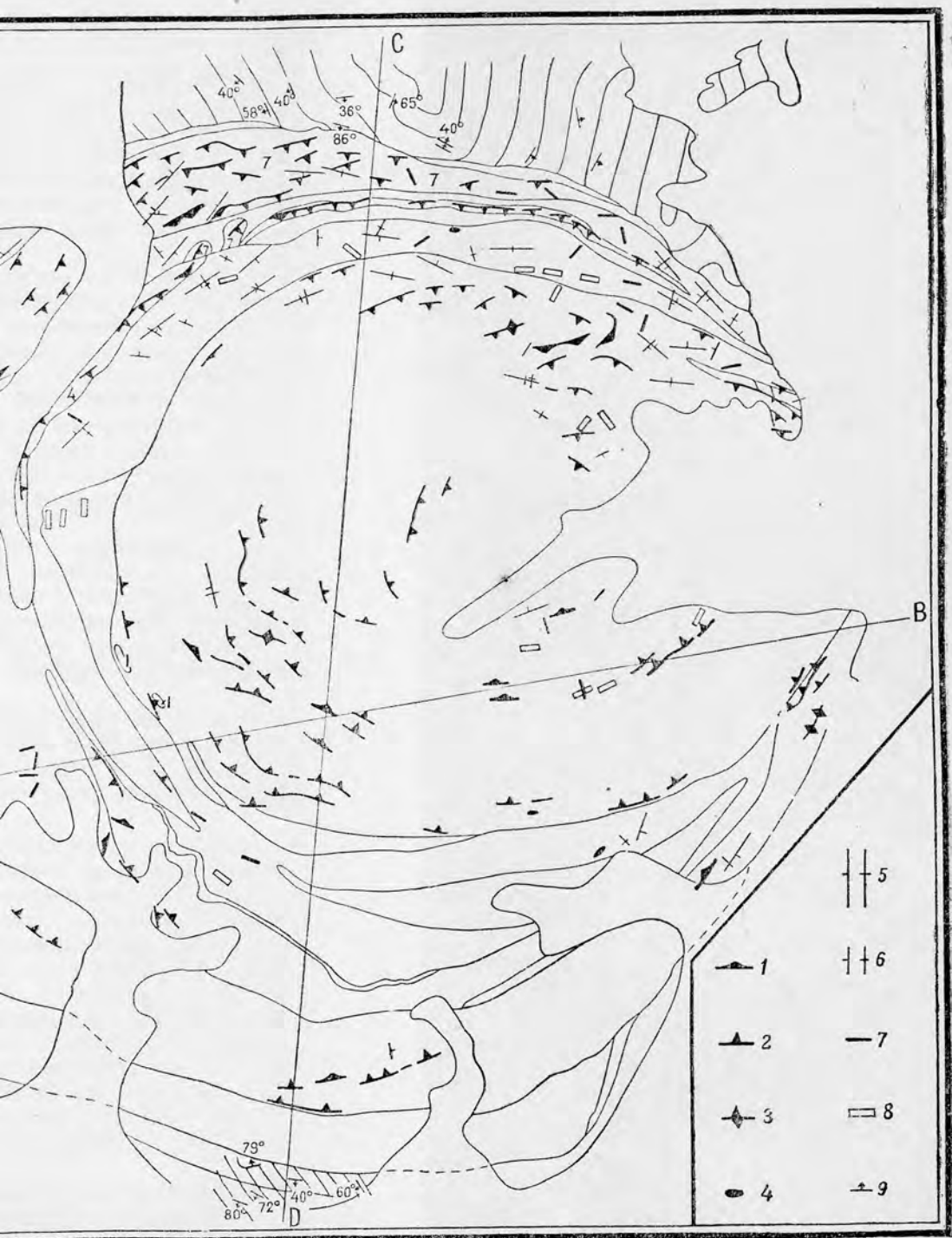
сиенитового плутона (составил Ожинский под редакцией Елисеева). 1. Склонность с углами падения от 35 до 80°. 2. Трахитоидность с углами падения от 80 до 90°. 3. Ориентированные шпильки. 4. Дайки и жилы трахитоидных пород. 5. Сланцеватость вмещающих пород. По параллельным линиям обозначено простирание вмещающих пород.
