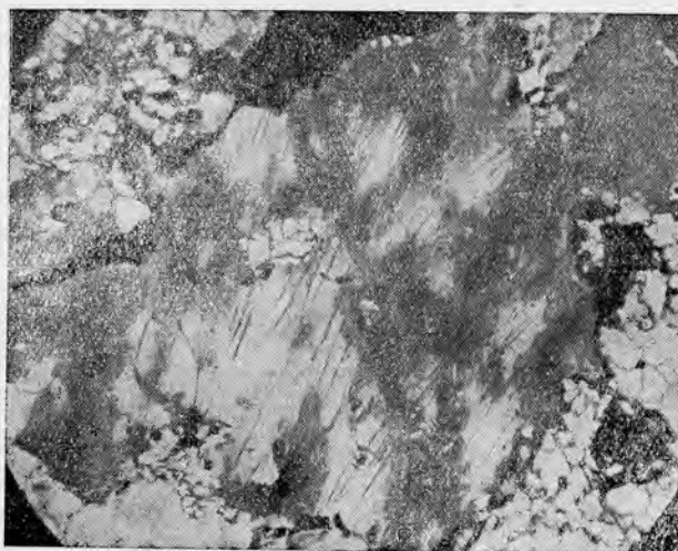
Рис. 120. Зерно кварца с полосками Бёма в сечении, перпендикулярном к оптической оси (по Хитанен).
