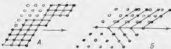
Рис. 103. Скольжение при помощи трансляции и скольжение при помощи двойникования.
