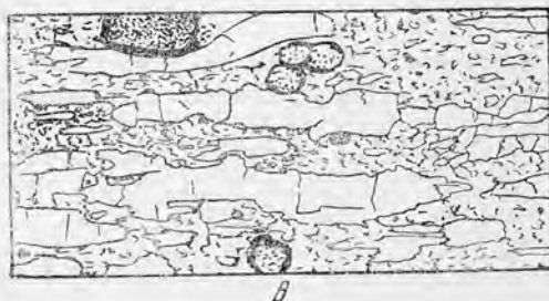
Рис. 129. А — таблитчатые кристаллы кварца в гранулите Финляндской Лапландии. Основная ткань состоит из кварца и полевого шпата и редких зерен граната и силлиманита. В — саксонский гранулит. Шлиф b \times 54 .
