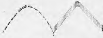
Рис. 147. Расположение пластинчатых минералов в складке изгиба и в складке скальвания (справа).
