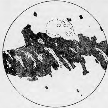
Рис. 170. Перистые трещины в обломке оталькованного серпентинита из рудной брекчии. Черное — рудные минералы. Светлое — оталькованный серпентинит, светлое с полосками — листочки талька. Увеличение 40.
