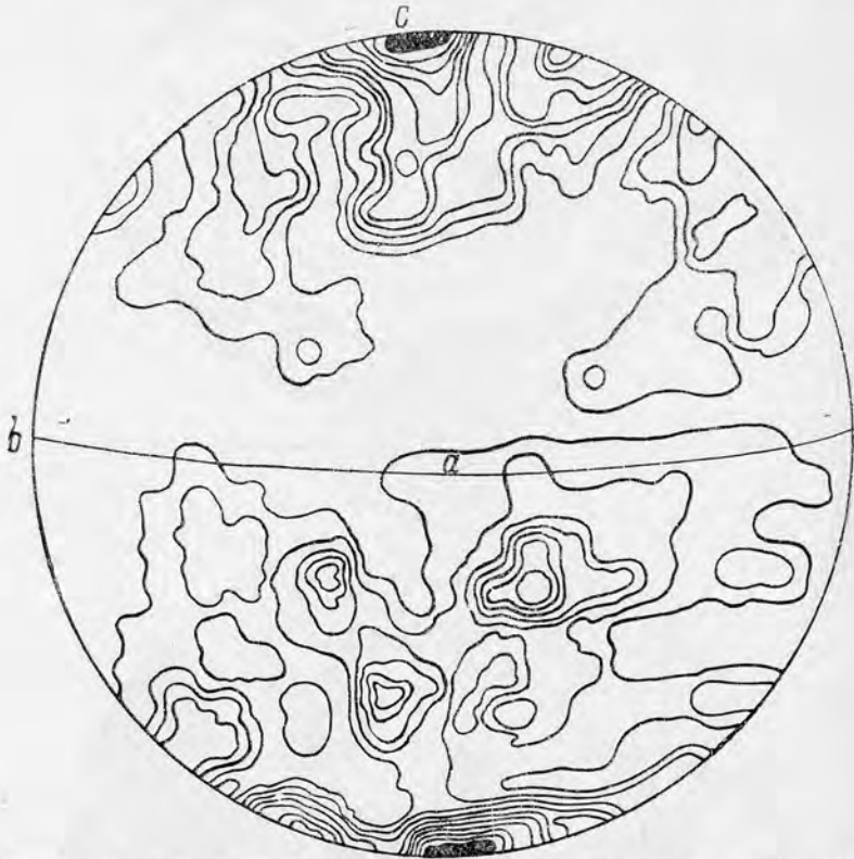
Рис. 164. Роговообманково-магнетитовые сланцы. 150 зерен кварца. Неполный пояс около оси b . Резко выраженный максимум, совпадающий с осью c , и отсутствие выходов оптических осей зерен кварца около оси a . Сложный тектонит, комбинация R- и S-тектонита. R=b , максимум около оси c указывает на дифференциальные движения в зернах кварца (ориентировка по правилу пинакоида), совершавшиеся параллельно кристаллизационной сланцеватости. \frac{2}{3}-1\frac{1}{2}-2-2\frac{2}{3}-3\frac{1}{3}-4-4\frac{2}{3}-5\frac{1}{3}-6-6\frac{2}{3}\% .
