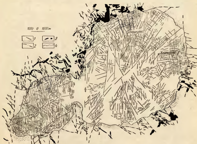
Рис. 223. Схема расположения крутопадающих трещин в Бектауатинском гранитном массиве (Казахстан). Составлено по аэрофотоснимкам В. С. Поповым, Г. Д. Аэровым, Ю. К. Кудрявцевым
