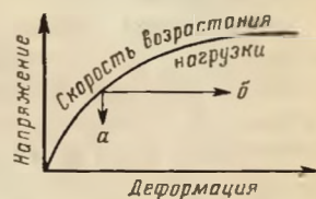
Рис. 21. Схема явления релаксации (а) и ползучести (б). По Я. Фридману
