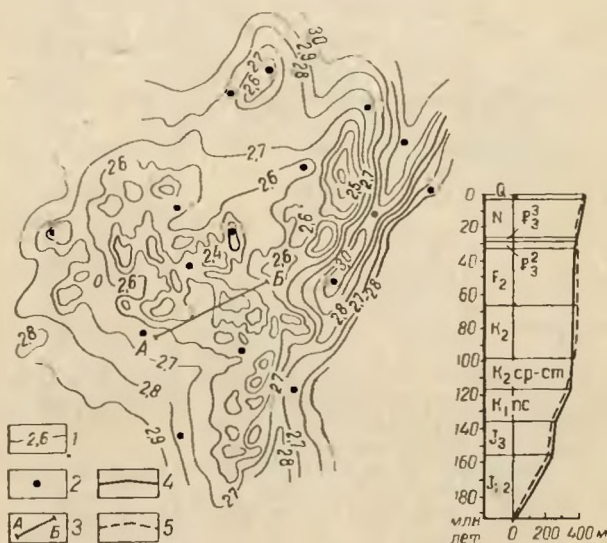
Рис. 246. Структурная карта Нижневолговского свода (по кровле среднеюрских отложений) и график движения. По М. Я. Рудкевичу
