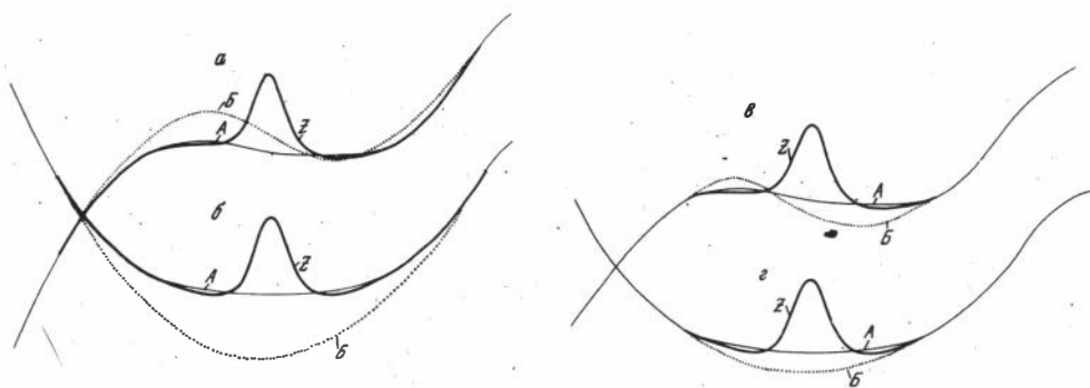
Рис. 1. Примеры определения нулевого уровня способами касательных в точках перегиба (а, б) и интерполяции полиномом Лагранжа (в, г), примененных Г.Ф. Кузнецовым (1965 1,2 и др.).
