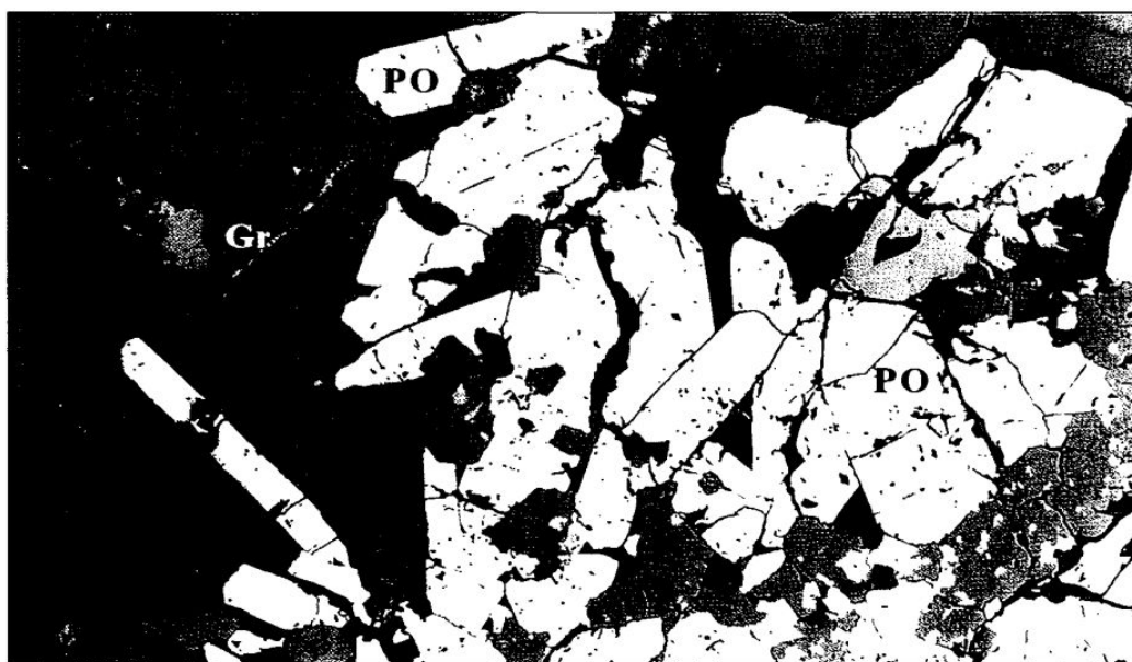
Рис. 25. Агрегат идиоморфных зерен гексагонального пирротина в мелилито-кальцитовом карбонатите; (ширина поля зрения 7,5 мм)
