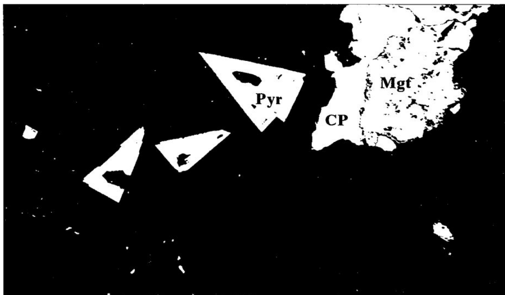
Рис. 23. Ксеноморфные зерна халькопирита и метакристаллы пирита во флогопито-кальцитовом карбонате; (ширина поля зрения 4,5 мм)
