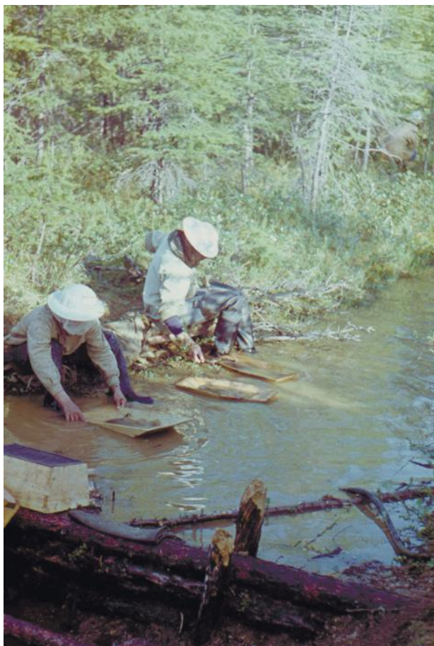
Доводка концентрата обогащения в промывочных лотках
