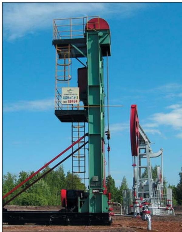
На снимке: первый длинноходовой цепной привод БМЗ на скв. 39454 НГДУ «Лениногорскнефть»
