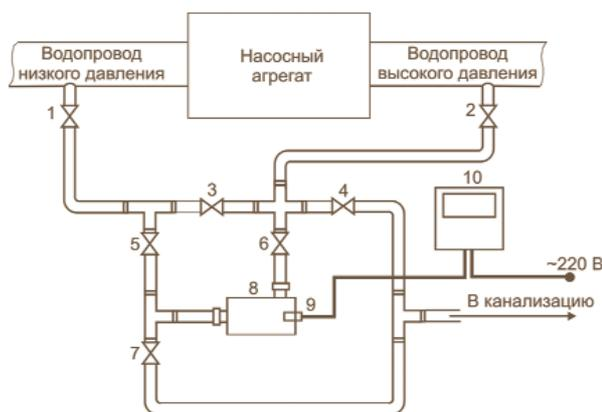
Рис. Схема подключения поточного анализатора кислорода РК-1:
