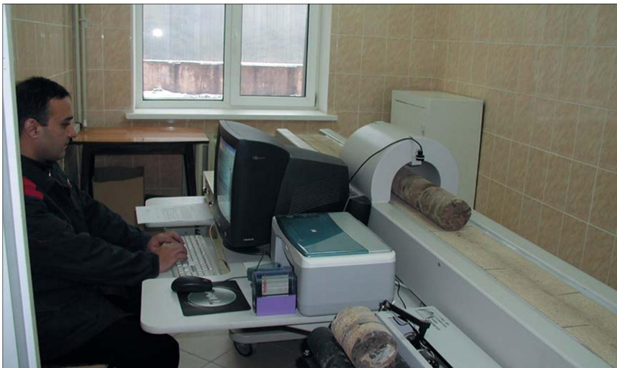
*На снимке: установки спектрального гамма-каротажа и анализа трещиноватости
