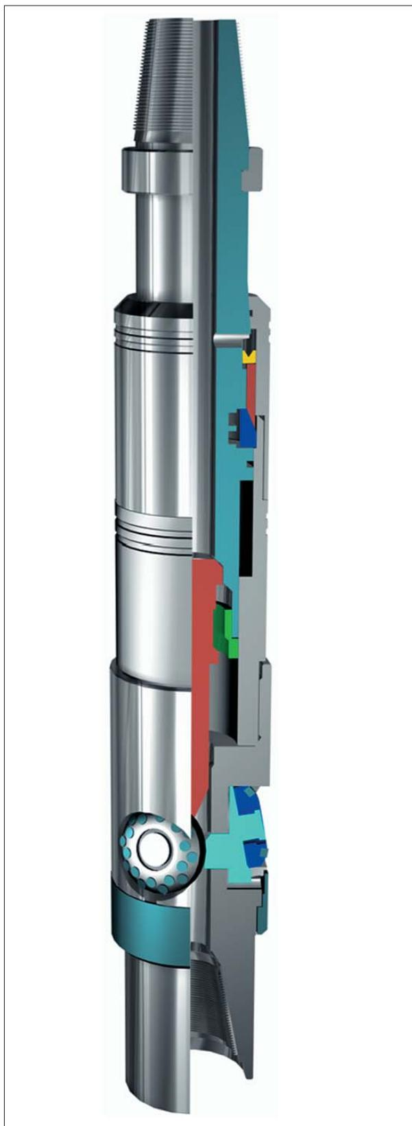
Рис. 4. Расширитель для калибровки эксплуатационной колонны
