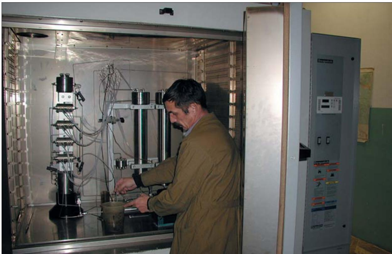
*На снимке: моделирование пластовых условий в фильтрационных экспериментах*
