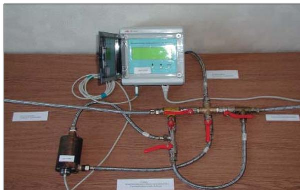
На снимке: поточный анализатор кислорода РК-1
