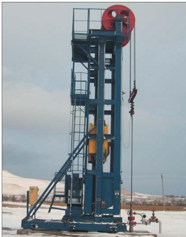
На снимке: первый длинноходовой привод ОАО «Ижнефтемаш» на скв. 23551 НГДУ «Иркеннефть»
