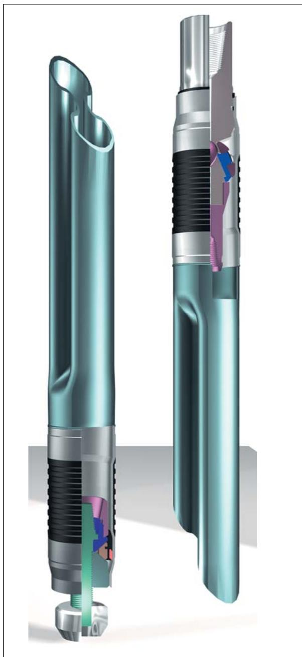
Рис. 6. Перекрыватель с подъемным башмаком
