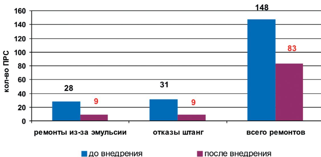
Рис. 3. Снижение количества ПРС до и после внедрения центных приводов с длиной хода 3 м
