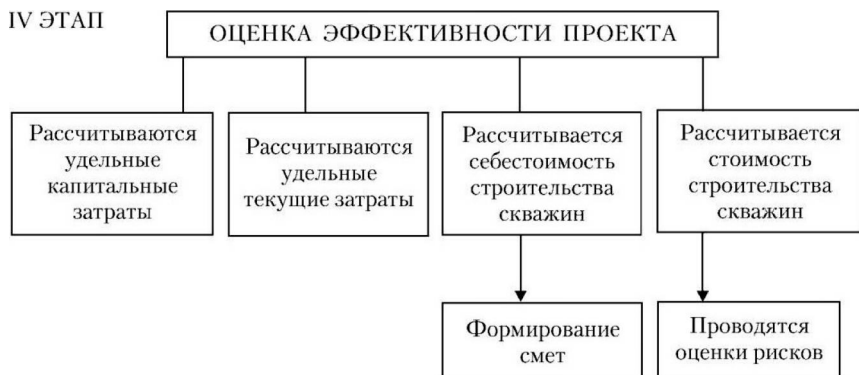
Рис. 8.1. Этапы проектирования строительства нефтяных и газовых скважин
