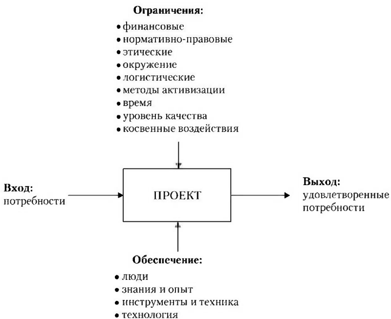
Рис. 1.1. Проект как процесс перехода системы из исходного состояния в конечное
