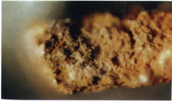
Рис. 7. Внутренняя структура пористого золота
