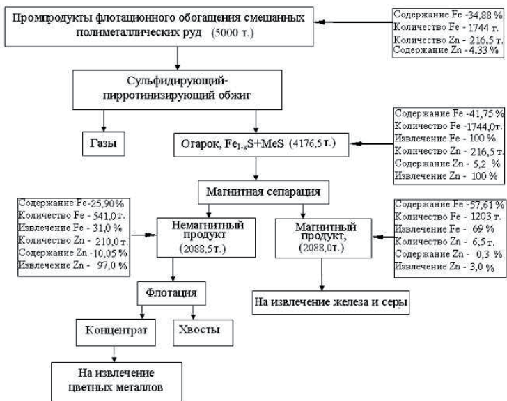
Рисунок В 1 – Технологическая схема переработки хвостов обогащения полиметаллической руды
