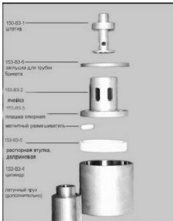
2. Соберите основные узлы устройства в соответствии с приведённым ниже рисунком и чертежом 150-80-МА. Подстройте высоту головки так, чтобы между нижней частью гайки на шпинделе и корпусом дифференциального датчика удлинения (ДДПУ), при отсутствии подложки для пробы, вставленной в цилиндр, образовался небольшой зазор (примерно 5 мм).
