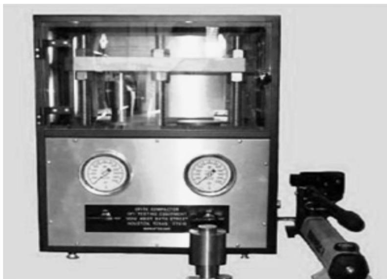
Рисунок 3.2 – Компактор для прессования образца в брикет
