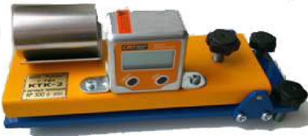
Рисунок 3.10 – Внешний вид прибора КТК-2 с электронным угломером
