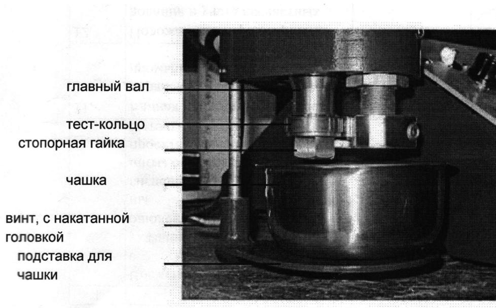
Рисунок 3 – Измерительная ячейка для теста на смазывающую способность
