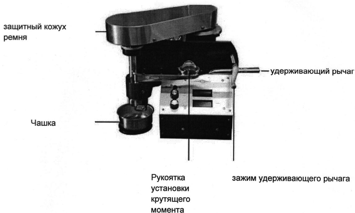
Рисунок 5 – Устройство в сборе
