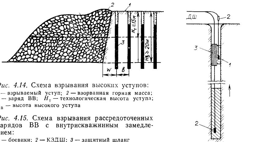
Рис. 4.14. Схема взрываия высоких уступов:
