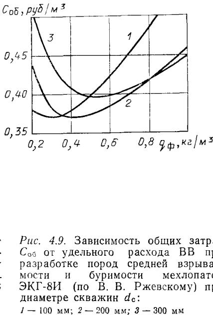
Рис. 4.9. Зависимость общих затрат  $C_{об}$  от удельного расхода ВВ при разработке пород средней взрываемости и буримости межлопатой ЭКГ-8И (по В. В. Ржевскому) при диаметре скважин  $d_{\phi}$ :
