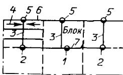
Рис. 3.14. Блоковый способ подготовки шахтного поля:
