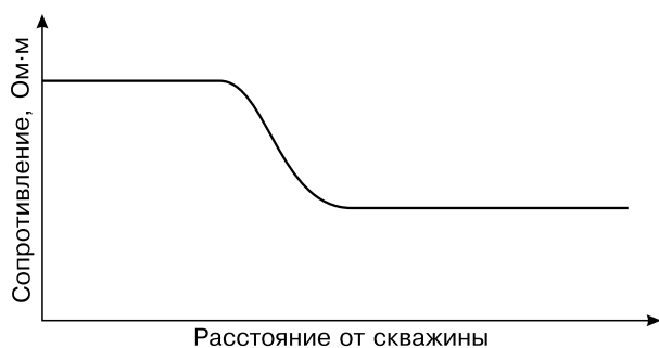
Рис. 2.2. Радиальное распределение УЭС в модели зона повышающего проникновения — пласт.
