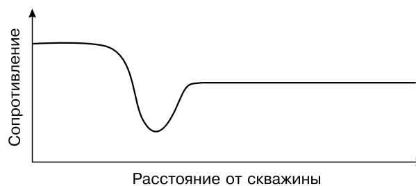
Рис. 2.6. Радиальное распределение УЭС при наличии окаймляющей зоны.
