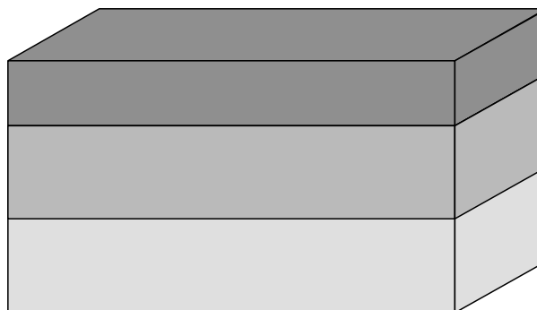
Рис. 2.10. Горизонтально-слоистая среда покрышка — пласт — подстилающая среда.
