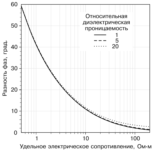
Рис. 3.3. Зависимость разности фаз от диэлектрической проницаемости однородной среды (зонд 0,5 м).
