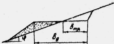
Рис. 3.4. Соединительная полутраншея в полувыемке-полунасыпи
