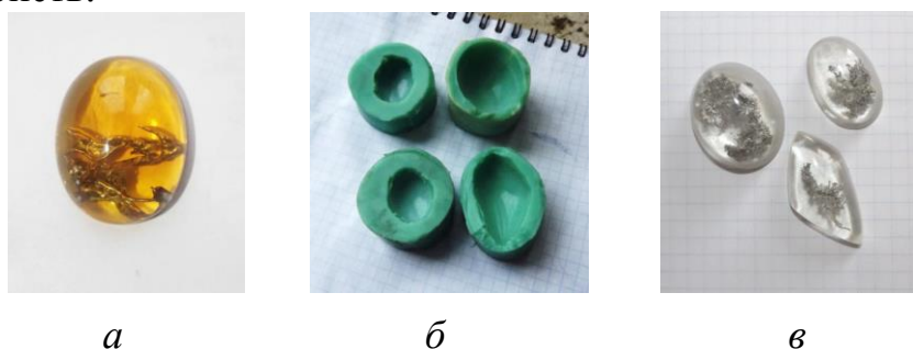
Рисунок 4 – Изготовление прозрачных вставок с имитациями серебряных самородков дендритоподобной текстуры внутри: а – кабошон из эпоксидной смолы, изготовленный на планшайбах; б – резиновые молды разных форм и размеров; в – полученные в них кабошоны
