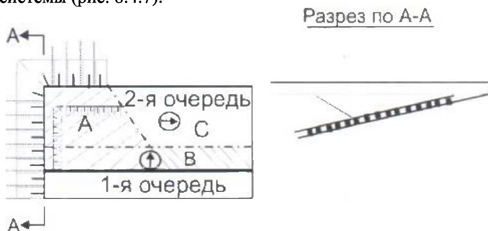
Рис. 8.4.7. Технология отработки карьерного поля с применением КГРП
