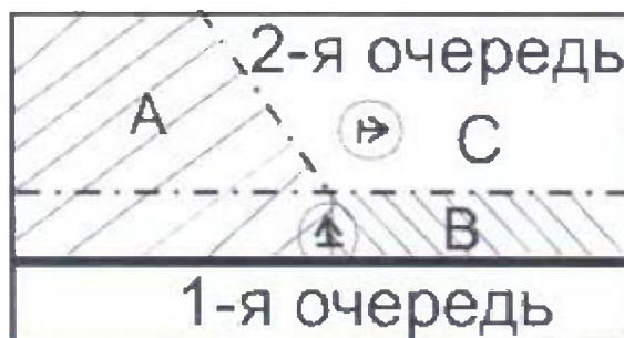
Рис. 8.4.6. Схема очередности отработки карьерного поля с выделением технологических частей
