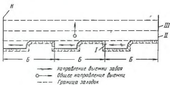
Рис. 187. План расположения заходок и блоков при выемке слоя:
