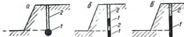
Рис. 199. Конструкции зарядов взрывчатых веществ в скважинах:
