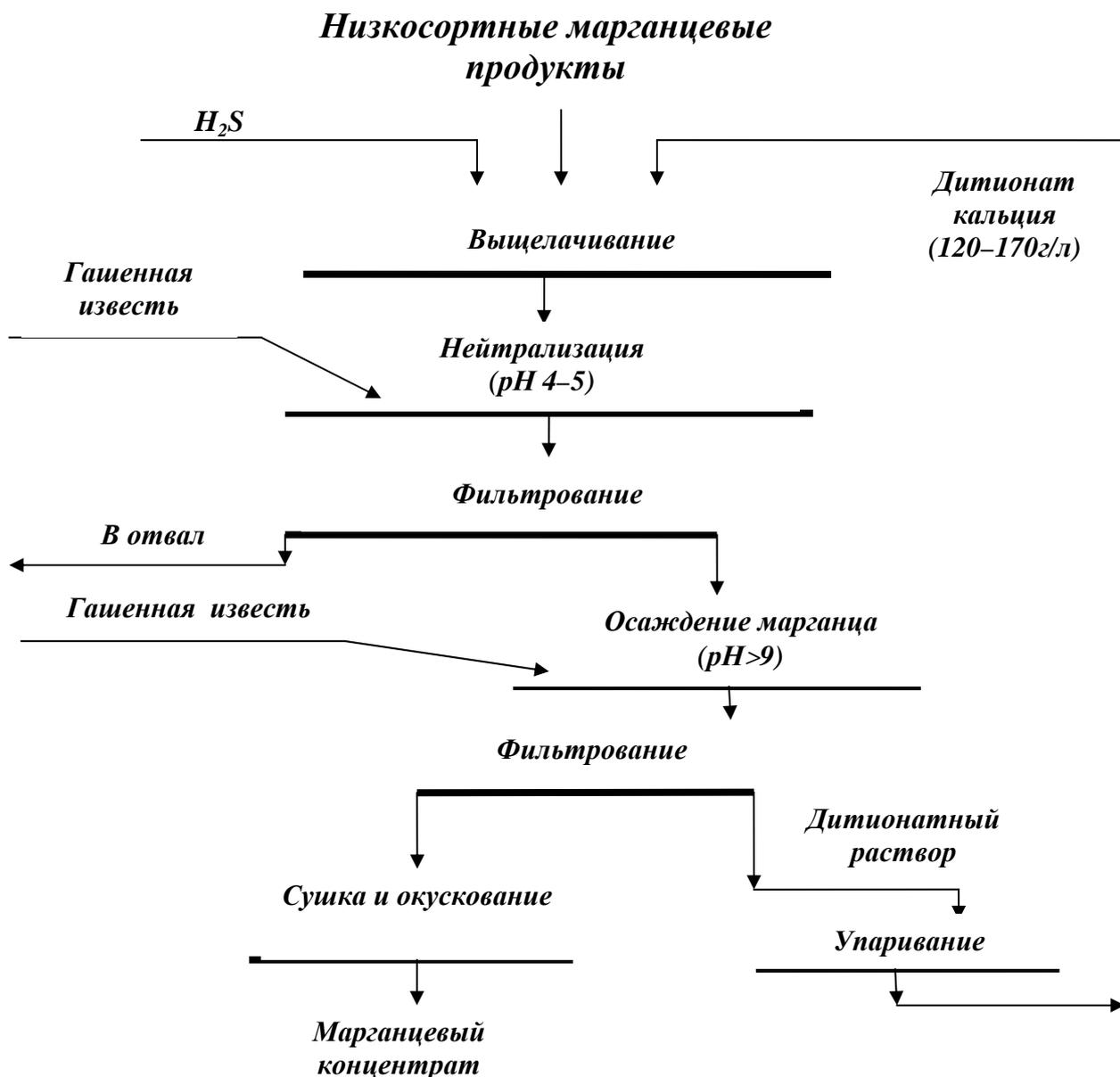
Рис. 2.1 – Схема переработки низкосортных марганцевых концентратов дитионатным способом
