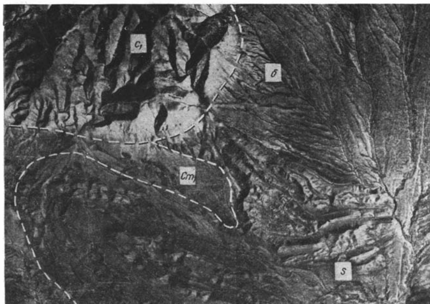
Рис. 18. Складки в породах силура. В верхнем левом углу снимка видно трансгрессивное перекрытие силурийских пород отложениями каменноугольного возраста, δ — дайки диабазов. Правый борт овра. Правый Кара-Суг. Масштаб ~ 1 : 40 000
