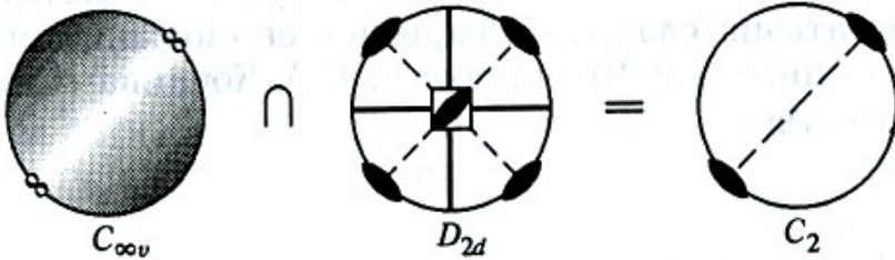
Рис. 27. Изменение симметрии кристалла дигидрофосфата калия в однородном электрическом поле: а – вектор напряженности поля направлен параллельно зеркально-поворотной оси 4-го порядка; б – вектор напряженности направлен параллельно плоскости симметрии; в – вектор напряженности параллелен оси 2-го порядка
