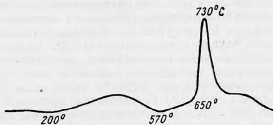
Рис. 30. Дифференциальная кривая нагревания синисита (обр. № 204).
