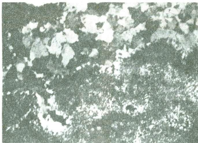
Рис. 7. Нарастание тонкого слоя микрзернистого кварца, сменяющегося тонкозернистым массивным, на почковидных скоплениях монтмориллонит-гидрослюдисто-кварцевого состава в основании ритма. Балейское рудное поле. Увел. 160^{\times} , николи +
