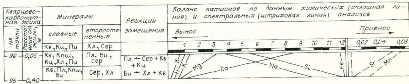
Рис. 37. Околорудные изменения при формировании кварцево-карбонатной минеральной ассоциации. Усл. обозн. см. на рис. 34.
