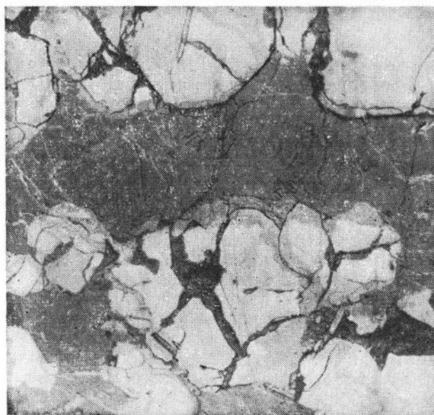
Рис. 79. Колломорфно-зональное строение пирохлора (компоненты с различной отражательной способностью). Черное — дефекты пилировки. Полир. шлиф, при одном никеле, увел. 150
