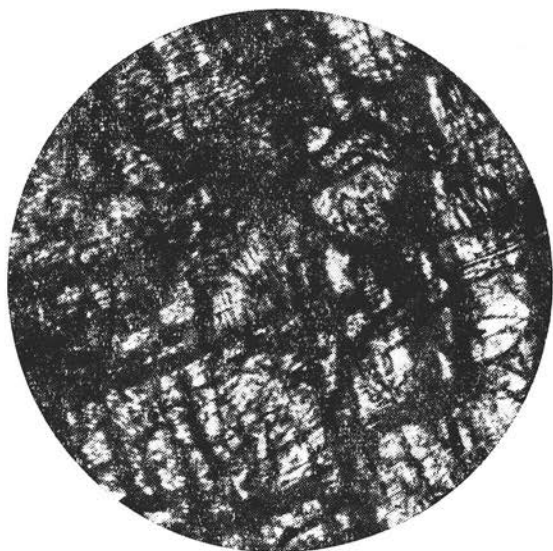
Рис. 48. Две спайности стибьотанталита. По направлениям спайности развиваются вторичные продукты. Прозр. шлиф при одном николе, увел. 200
