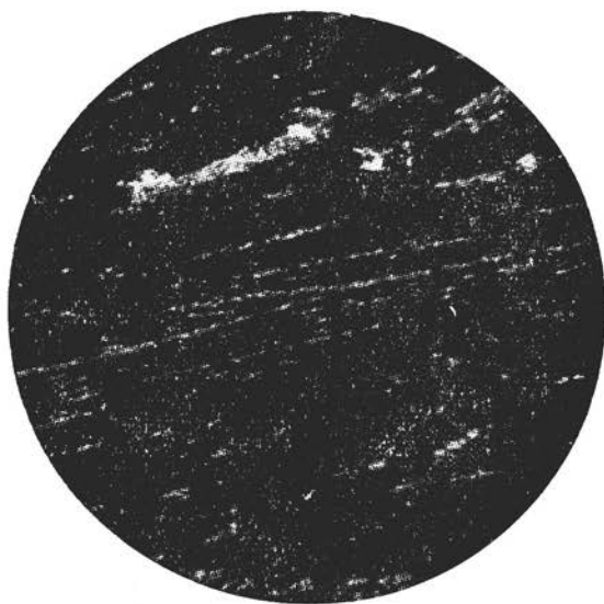
Рис. 39. Вольфрамоксиолит с микроклином, развивающимся по спайности. Прозр. шлиф, при одном николе, увел. 160
