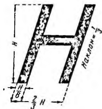
Рис 60. Стандартный шрифт. Цифры показывают последовательность, а стрелки — направление написания букв
