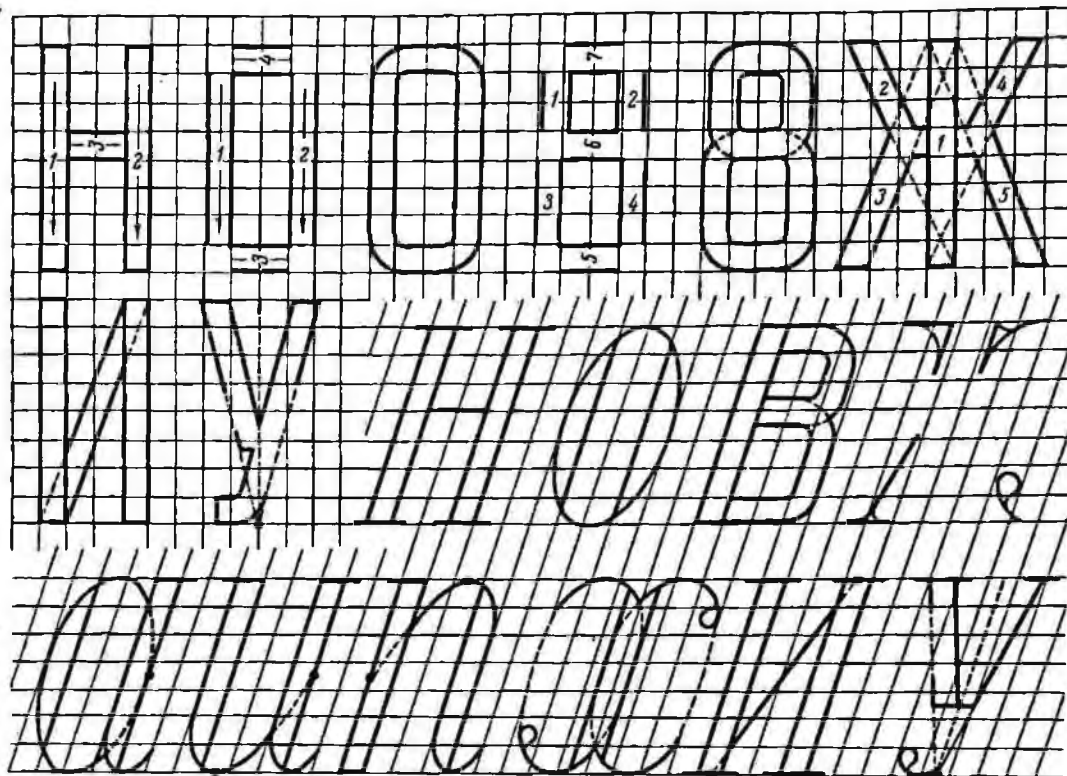
Рис. 27. Построение и вычерчивание элементов букв. (Цифры показывают последовательность вычерчивания)
