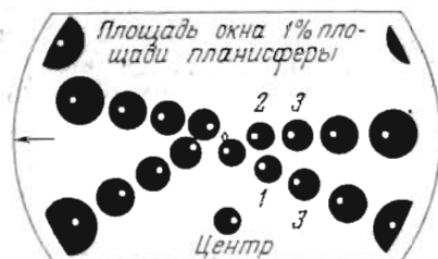
Рис. 58. Шаблон для пересчета площади планисферы сетки Вульфа. По А. В. Пронину
