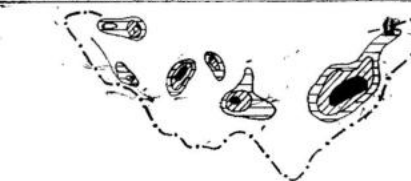
Рис. 2. Распределение мощностей метасоматитов, руд и концентраций рудных элементов на продольной вертикальной проекции рудных зон месторождения (значения параметра увеличивается в соответствии с увеличением густоты штриховки)
