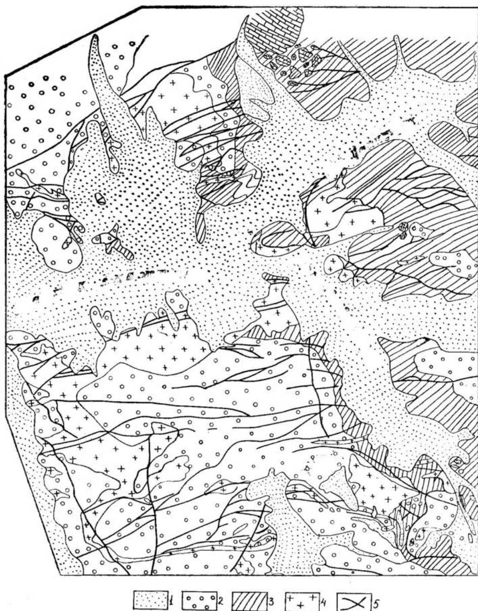
Рис. 2. Схематическая геологическая карта рудного поля (масштаб 1:10 000): 1 — четвертичные отложения; 2 — среднекаменноугольные конгломераты ороговикованные, скарнированные, окварцованные; 3 — нижнекаменноугольные алевролиты с известковистыми горизонтами и глыбами известняков, ороговикованные известковистые породы скарнированные и мраморизованные; 4 — интрузивные образования комплекса субвулканических малых интрузий — гранодиорит-порфиры и кварцевые диоритовые порфиры; 5 — рудные жилы
