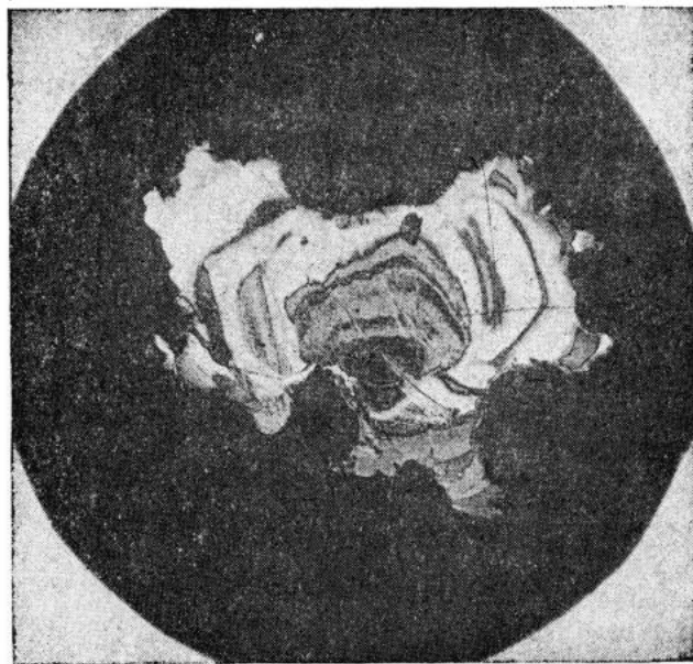
Рис. 1. Выделение контрастнозонального позднего золота (темное) по границам зон роста раннего золота (светлое). Монтированный аншлиф, протравленный раствором хромового ангидрида в соляной кислоте, ув. 200 (образец Ю. С. Бермана)
