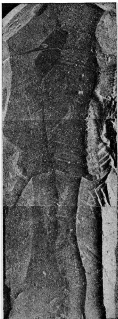
Рис. 3. Микроморфология удлиненного кристалла, показанного на рис. 2 (во вторичных электронах). Из снимках видны субиндивиды двойника и изменение микро рельефа по разные стороны двойниковых швов; а) ув. 380, б) ув. 300
