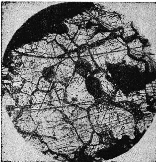
Рис. 2. Цементация дезинтегрированных зерен утратившего зональное строение низкопробного золота (светлое) прожилками высокосеребристого контрастнозонального золота. Монтированный аншлиф, протравленный раствором хромового ангидрида в соляной кислоте, ув. 450.
