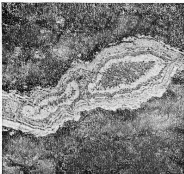
Рис. 3. Ритмично-зональные образования самородного серебра (светлое), акантита (темное) и окислов железа. Полированный шлиф, ув. 200
