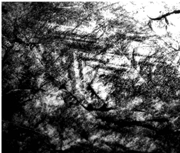
Рис. 4.2. Флюидные ультрамикроскопические включения в известняках верхнего мела Черногорской моноклинали (Восточное Предкавказье) под сканирующим электронным микроскопом
