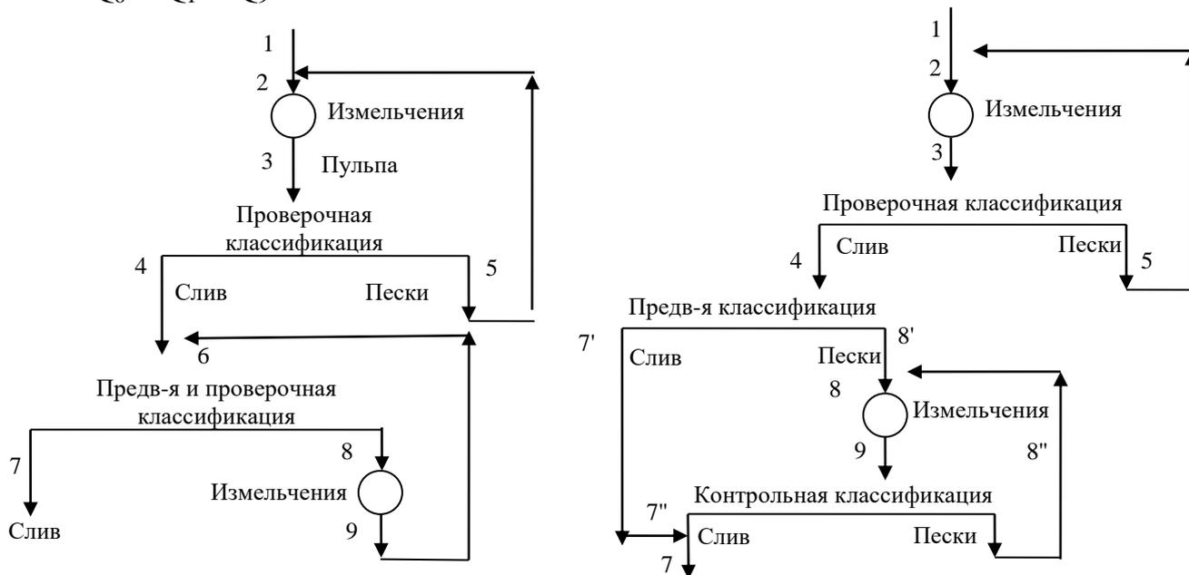
Рис. 6. Схемы измельчения ВА и ВА<sup>1</sup>
