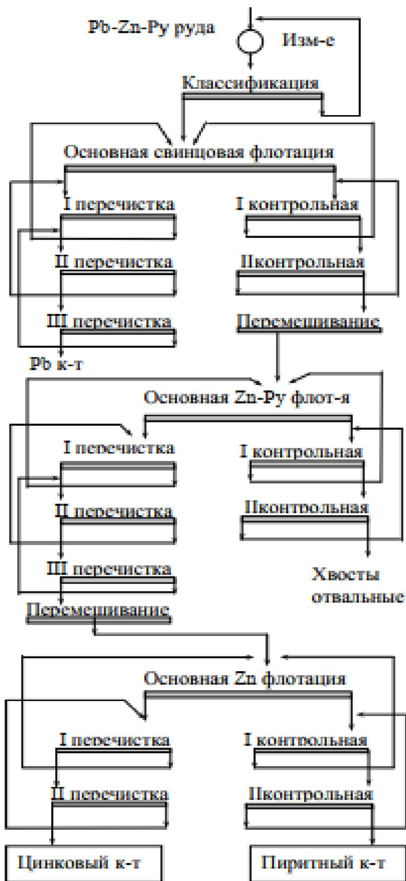
Рисунок 5.1 – Технологическая схема переработки Рb – Zn руд
