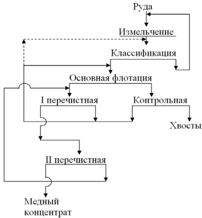
Рис. 24. Одностадийная схема флотации медных руд
