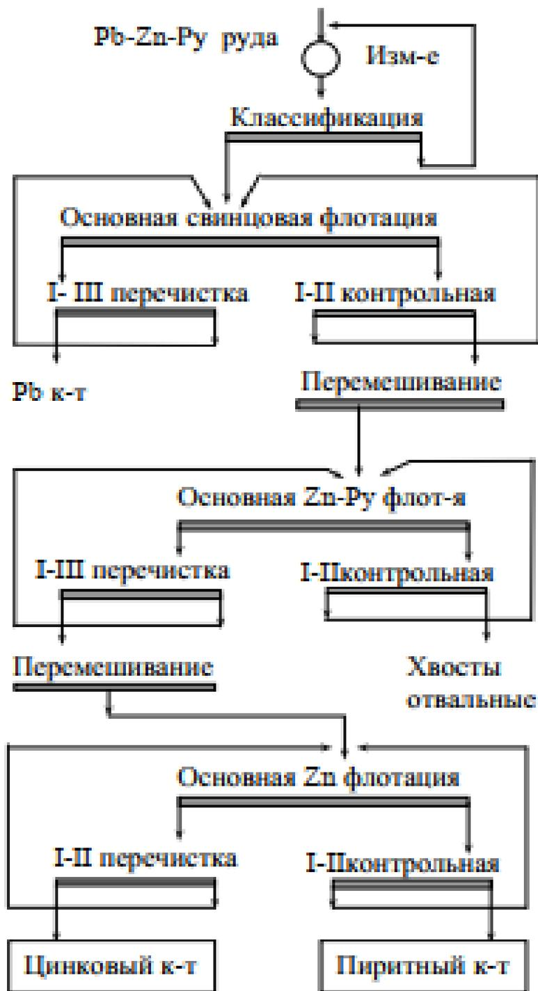
Рисунок 5.2 – Технологическая схема переработки Pb – Zn руд (Упрощённый вариант)
