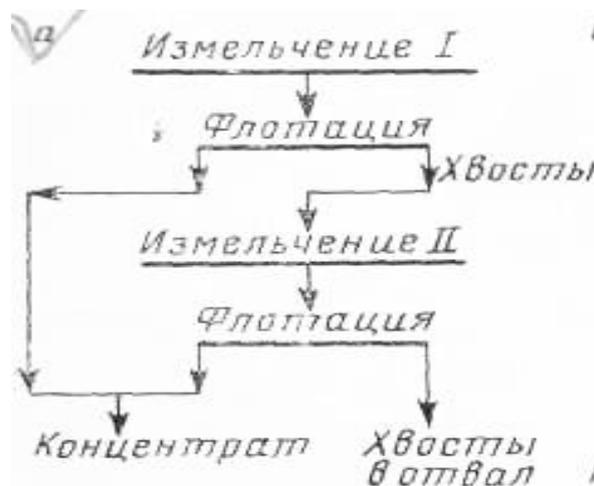
Рис. 1.6. Двухстадиальная схема флотации медных руд.
