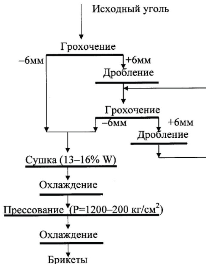
Рис. 1.6. Схема брикетирования бурых углей
