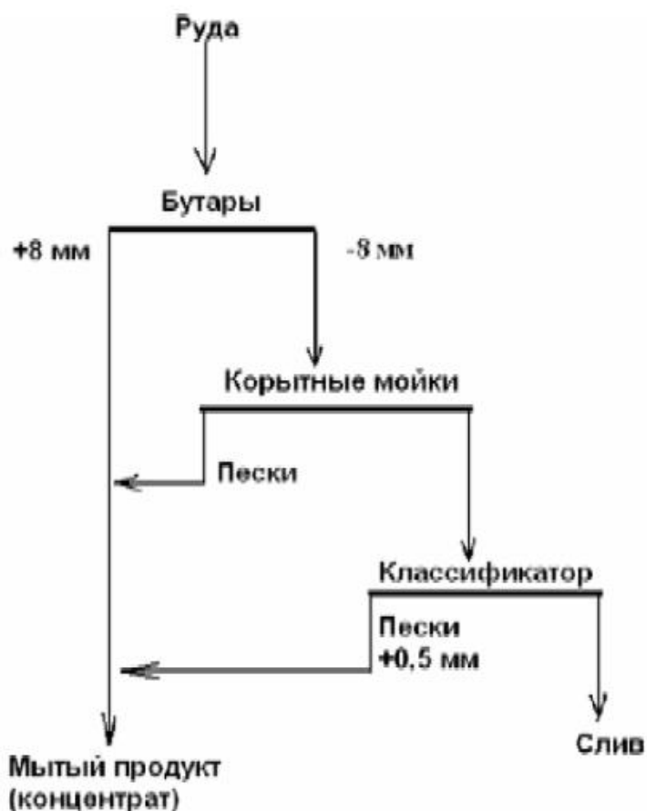
Рис. 9.1. Схема промывки руды на рудомойке № 1 Егорьевского рудника
