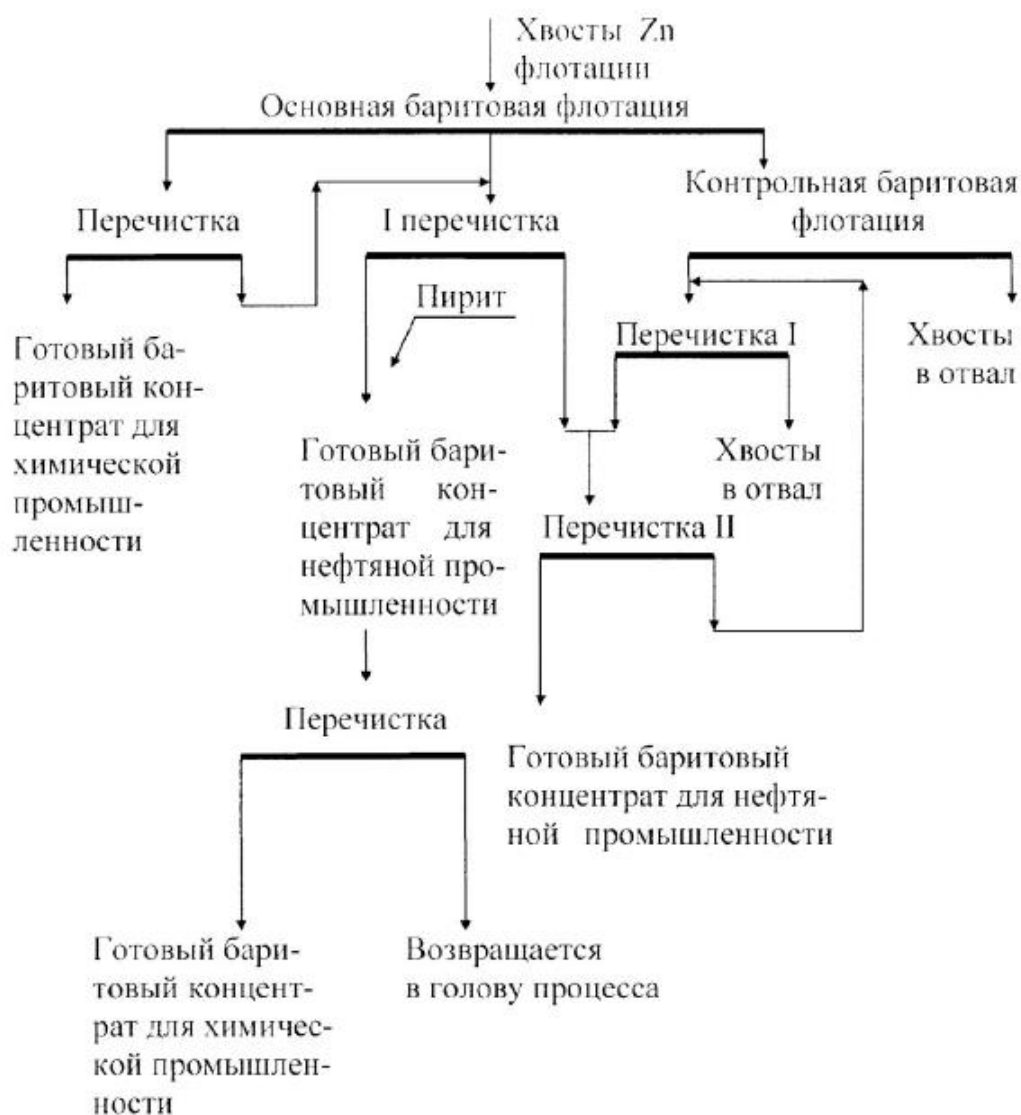
Рис. 4.1. Схема обогащения барита на Салаирской фабрике
