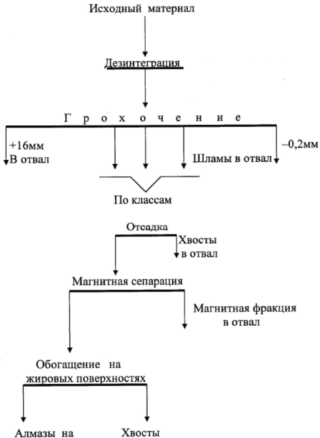
Рис. 3.2. Схема обогащение алмазосодержащих россыпей
