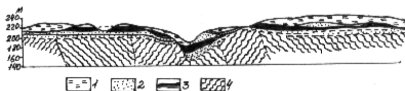
Рис. 19. Геологический разрез Часовоярского месторождения огнеупорных глин (по В.Ф. Дыбкову, А.Е. Карякину, В.Д. Никитину, П.М. Татаринцеву): 1 – суглинок; 2 – песок; 3 – огнеупорная глина; 4 – отложения мезозоя и палеозоя
