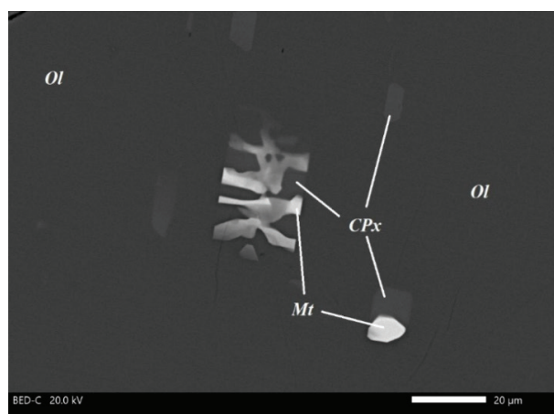
Рис. 2. Включения в зернах оливина оливинитов Лесной Варакки. Слева – магнетит-диопсидовые сростки, справа – включение карбонатитового расплава
