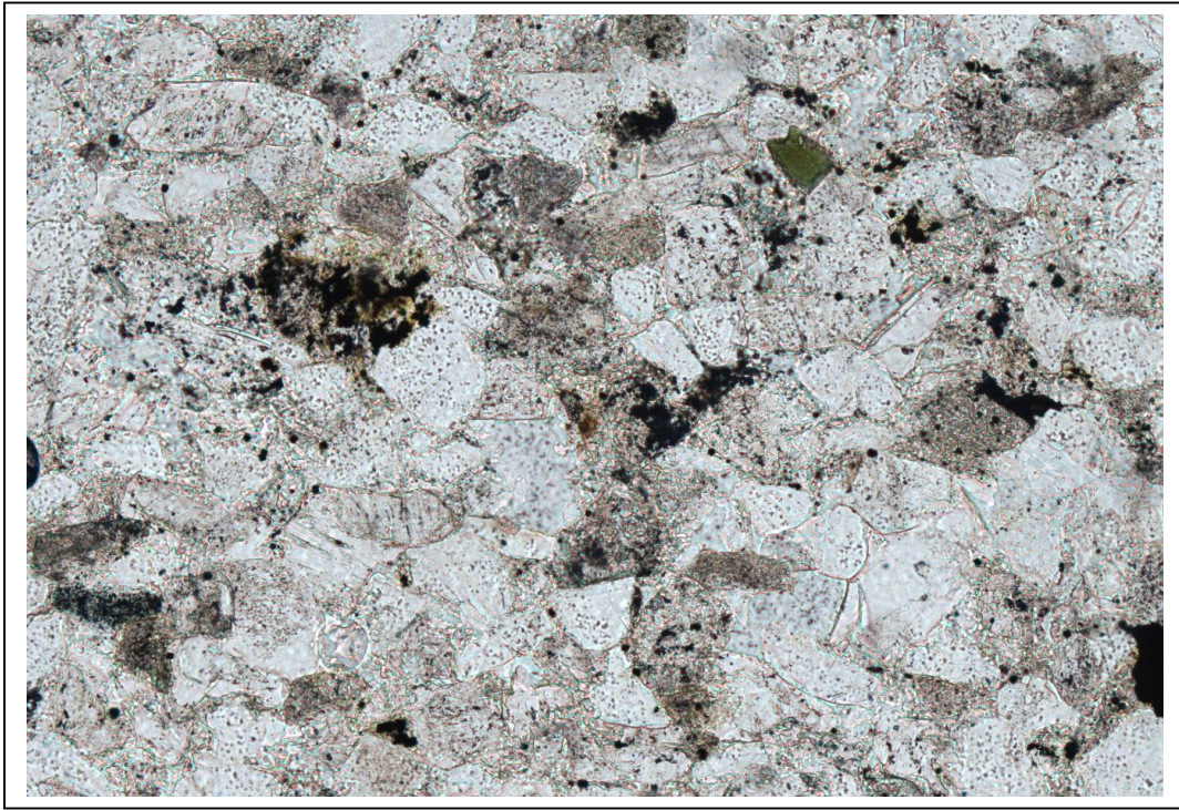
Рисунок 2.10 - Порový глинистый цемент в песчанике мелкозернистом алевритистом. Платоновская скв. 1. Глубина отбора 2712,56 м. Николи параллельны
