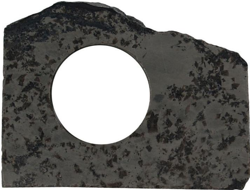
Рисунок 3.15 - Идиоморфные ромбовидные кристаллы доломита в глинисто-карбонатной породе. Скважина Платоновская 1
