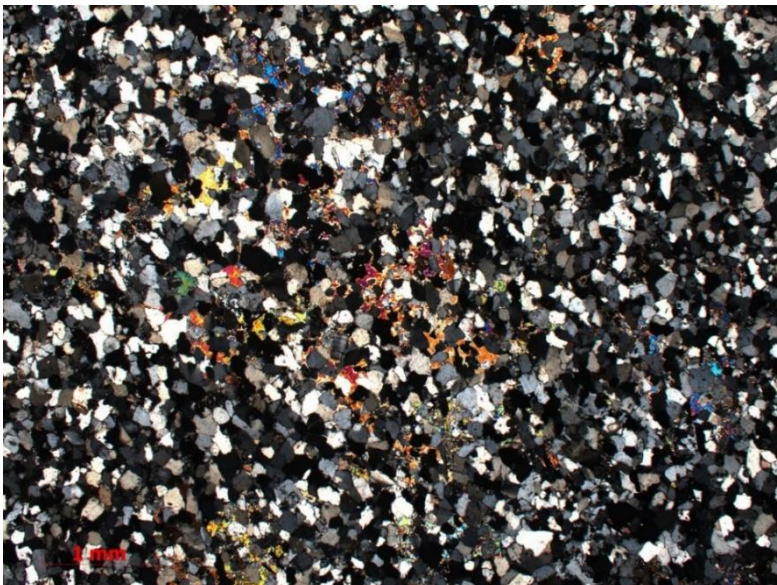
Рисунок 4.1 - Сульфатизация пустотного пространства в песчанике мелкозернистом. Николи скрещены. Глубина отбора 4492,5 м. Скважина Чунская 1. Пласт Б7
