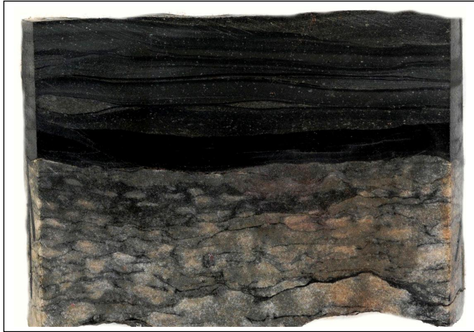
Рисунок 2.17 - Флазерная слоистость в аргиллитах алевритистых. Оморинская скв. 1. Глубина отбора 2547,49 м
