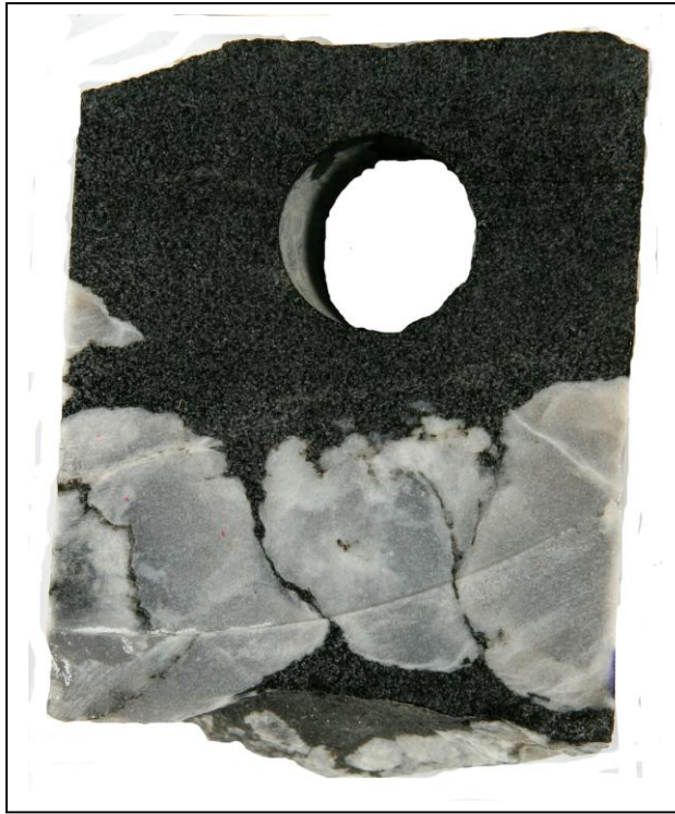
Рисунок 2.24 - Неяснослоистая и линзовидная текстуры в доломите разнокристаллическом алевро-песчано-глинистом (оскобит). Камовская скв. 2. Глубина отбора 2456,15 м
