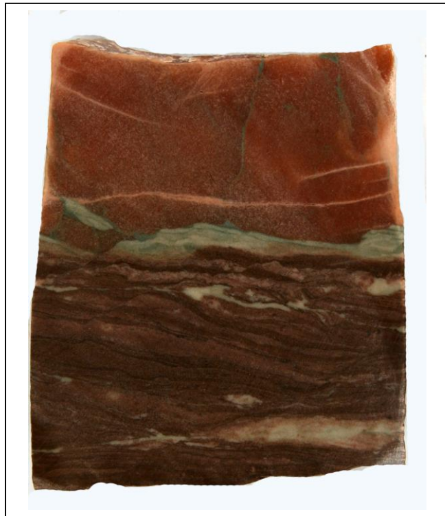
Рисунок 2.28 - Текстуры смещения слоев, слоистая, линзовидная в доломите тонко и мелкозернистом железистом. Платоновская скв. 1. Глубина отбора 2645,46 м
