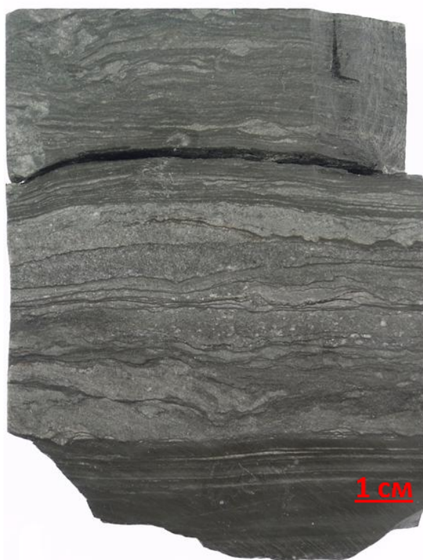
Рисунок 3.24 - Волнистослоистые, линзовидные в алеволитах глинистых. Скважина Платоновская 2. Фация верхних частей конуса выноса временных потоков
