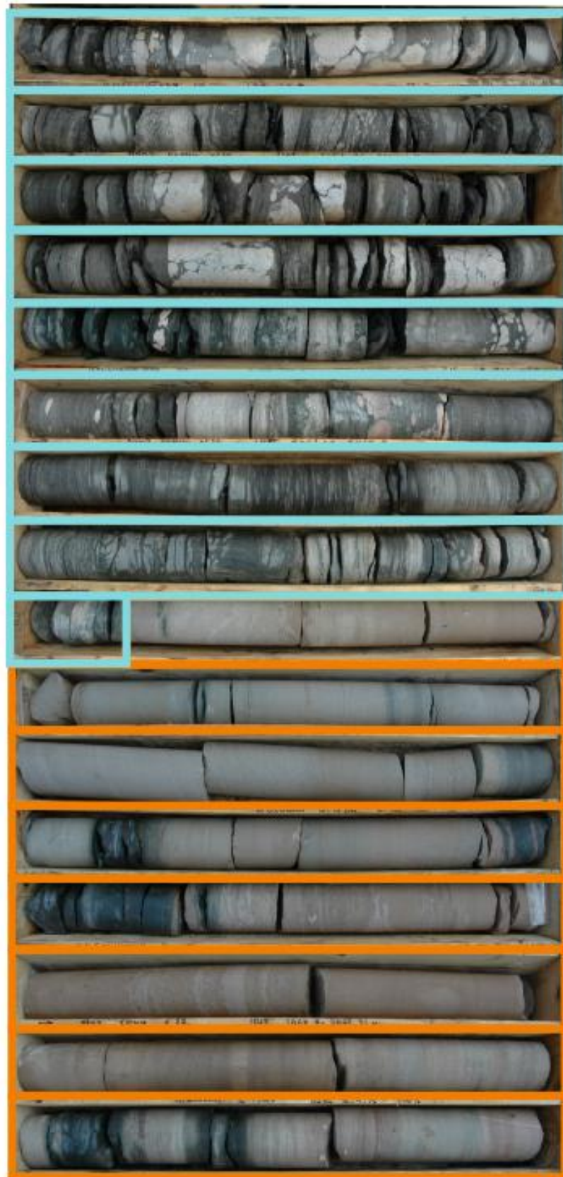
Рисунок 3.30 - Песчаники с редкими глинистыми прослоями (аккумулятивные формы конусов выноса временных потоков – показано оранжевым) и алевро-глинисто-сульфатные отложения, сформированные в условиях мелководных частей прибрежных соленых озер (выделено голубым цветом). Скважина Ильбокичская №5, интервал 2451,92 – 2477,35 м
