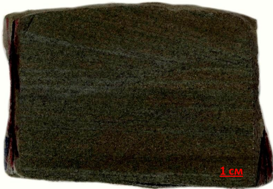
Рисунок 3.22 - Косослоистые и горизонтальнослоистые текстуры фации верхней части конуса выноса временного потока. Скважина Платоновская 2
