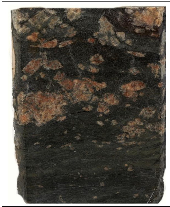
Рисунок 2.21 - Линзовидная текстура в алевро-глинисто-карбонатных породах (оскобитах). Оморинская скв. 1. Глубина отбора 2497,45 м
