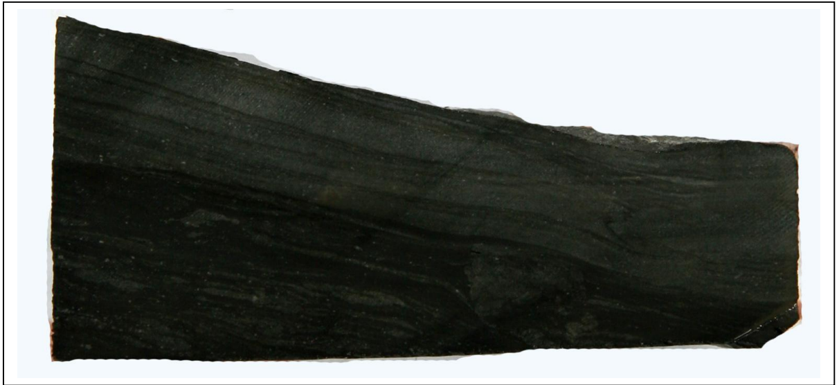
Рисунок 2.14 - Наклонная слоистость и следы биотурбации в алевролите мелкозернистом доломитизированном глинистом. Платоновская скв. 1. Глубина отбора 2703,28 м
