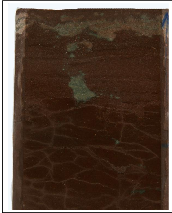
Рисунок 2.3 - Неясная и линзовидная слоистость в песчанике разномзернистом с глинистым и железистым цементом. Платоновская скв. 1. Глубина отбора 2676,10 м
