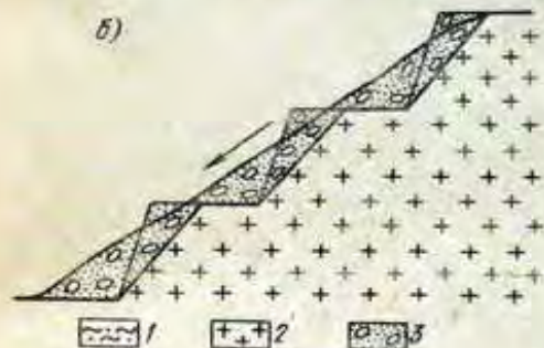
Рис.6. Схема покровных оползней: а - слабых пород; б - продуктов выветривания 1 - слабые породы, 2 - коренные породы; 3 - продукты выветривания
