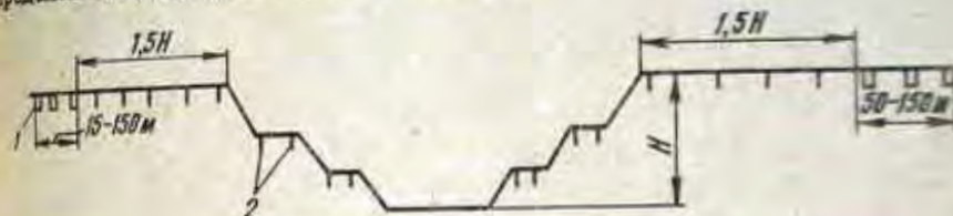
Рис.29. Профильная линия опорных 1 и рабочих 2 реперов для инструментальных наблюдений
