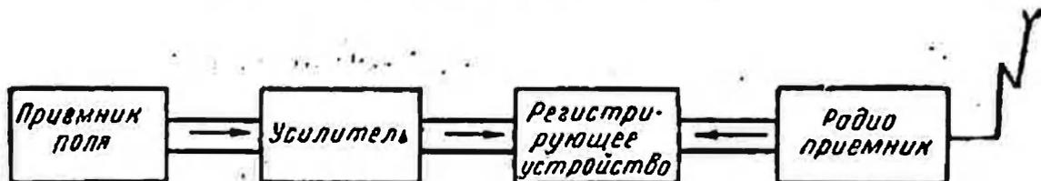
Рис. 8. Блок-схема приемной станции
