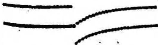
Рис. 18. Переходный процесс при изменении полярности прямоугольного импульса
