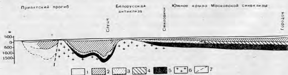
Рис. 20. Схематический геологический профиль через Припятский прогиб, Белорусскую антеклизу и южное крыло Московской синеклизы (по Е. П. Брунс):
