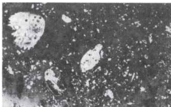
Рис. 43. Брекчиевый фосфорит с заполняющим фосфатизированным нанофораминиферовым илом Прозрачный шлиф, николи II. Гайот Батиса, обр. Д9821А
