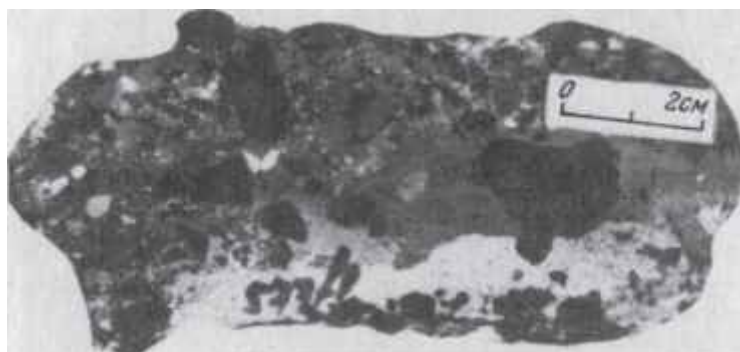
Рис. 40. Фосфатная брекчия (брекчиевый силикатный фосфорит), слоистая, с разновеликими обломками вулканитов, замещенных частично гидрооксидами железа и марганца. Гайот Макдонелл, обр. Д577/1
