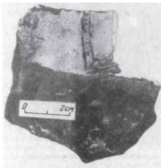
Рис. 44. Брекчиевый фосфорит (фосфатная брекчия) с крупными, резкоугловатыми обломками более ранних фосфоритов по наноилу (?)
