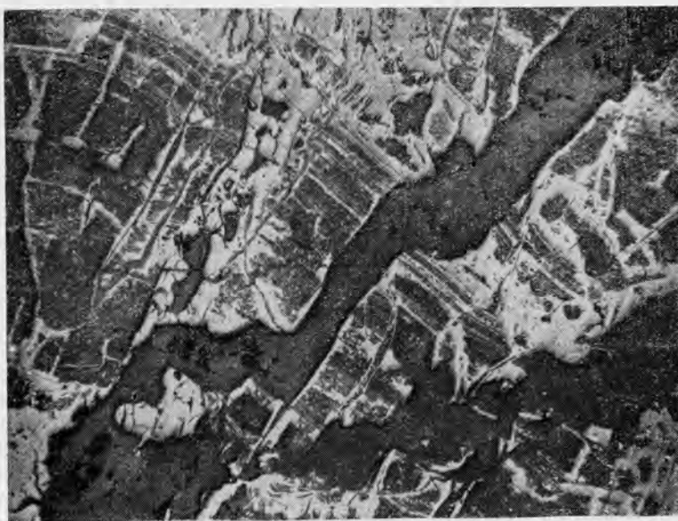
Рис. 8. Сложная псевдоморфоза настурана (белый) и кальцита (темно-серый) по коффиниту. Настуран по коффиниту сохраняет нетронутыми ранее существовавшие в измененном коффините трещины.
