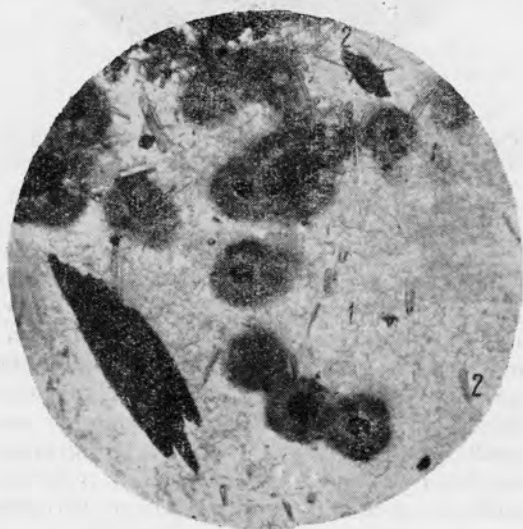
Рис. 11. Дворики из темно-бурой гидрослюды вокруг кристаллов уранинита в тальке (1 — тальк; 2 — родусит; черное — гематит). Прозрач- ный шлиф. \times 155 .
