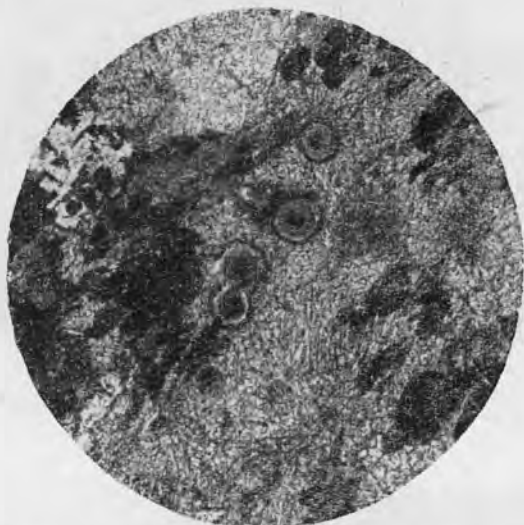
Рис. 6. Дворики в эгирине с альбитовым кольцом (белое). В центре двориков — хлорит. По периферии — изотропная зона и плеохроичная кайма (светло-серое — карбонат; черное — гематит). Прозрачный шлиф. \times 40 .
