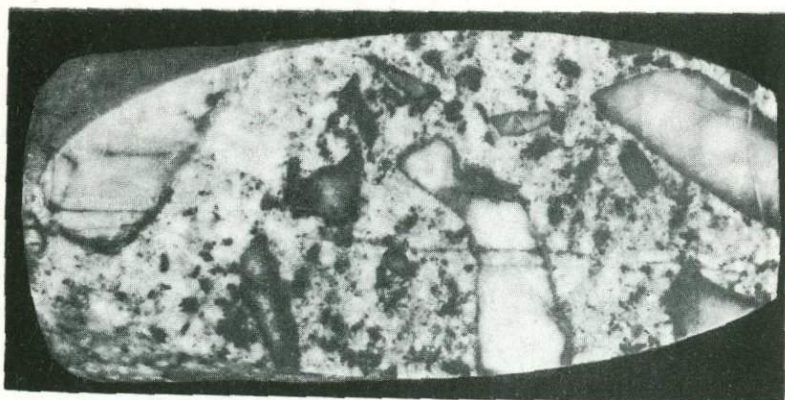
Р и с. 4. Брекчия диопсидового скарна в материнском роговообманковом граните. Темные каемки вокруг обломков скарна — хлорит. Месторождение Ольховское, Дистлеровский участок, полир. штупф, натур. вел., коллекция В.В. Черняева
