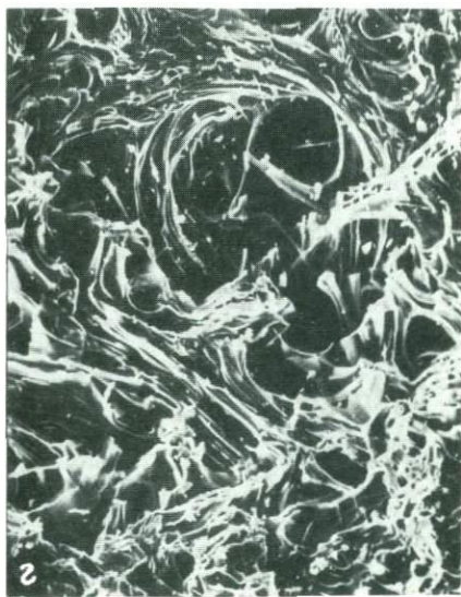
зновидности структуры пористых стекол под сканирующим электронным микроскопом примере месторождений Гегамского нагорья, АрмССР; увел. 2000 а — плотное; б — слабопористое; в — пористое; г — пемзовидное
