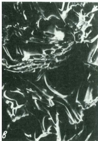
зновидности структуры пористых стекол под сканирующим электронным микроскопом примере месторождений Гегамского нагорья, АрмССР; увел. 2000 а — плотное; б — слабопористое; в — пористое; г — пемзовидное
