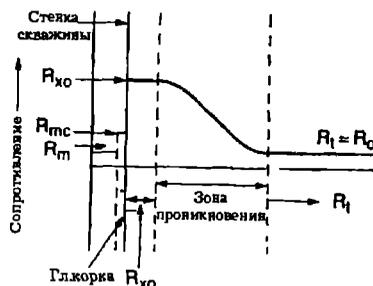
Радиальное распределение сопротивления ( $R_{mf} > R_w$ . Пласт водонасыщенный)
