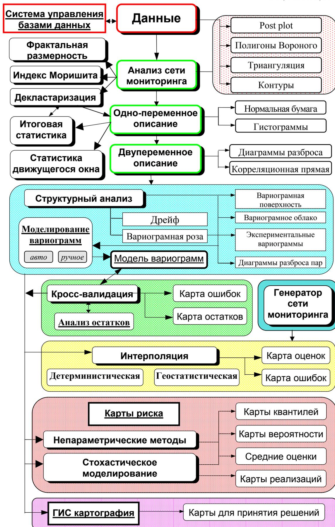
Рисунок 1. Схема методологии анализа, обработки и представления пространственно-распределенных данных.
