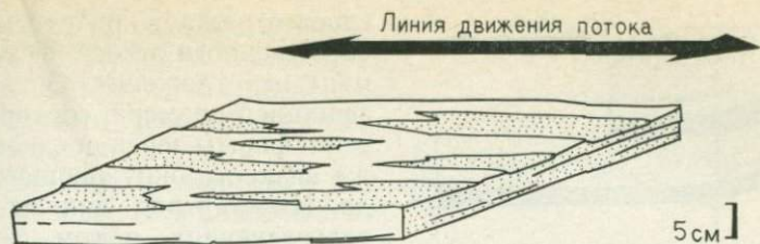
Фиг. 74. Схема течения или линейности течения на поверхности слоя. Проявляется как зернение на плоскостях слоистости, умеренно сцементированных, способных раскалываться по этим плоскостям песчаников; указывает на путь движения потока, а не на само направление
