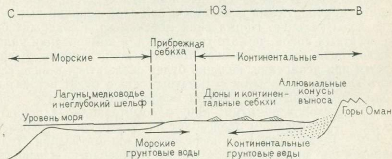
Фиг. 58. Схематический разрез на побережье Персидского залива, переход от аридной континентальной обстановки к обстановке открытого моря
