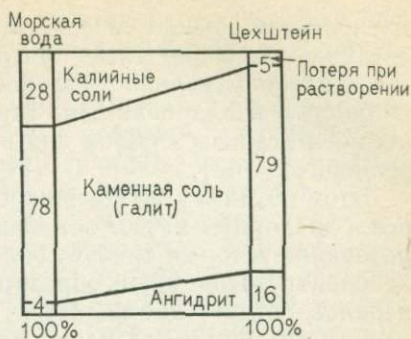
Фиг. 47. Сопоставление колонок процентного содержания эвапоритовых минералов, образующихся при испарении средней морской воды и наблюдаемых в цехштейновых эвапоритах в бассейне Северного моря
