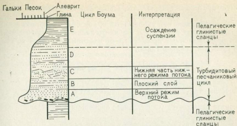
Фиг. 66. Турбидитовый ритм с полным циклом Боума и интерпретация осадков с позиции изменения режима потока.
