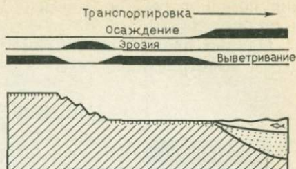
Фиг. 18. Схематический разрез, показывающий, что выветриванию благоприятствует низкий рельеф, так как в этих участках скорость эрозии достаточно низка. Высота над уровнем моря не имеет существенного значения
