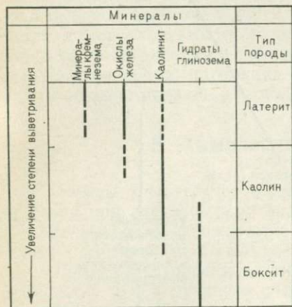
Фиг. 21. Минеральные составы остаточных отложений, образованные при интенсивном химическом выветривании
