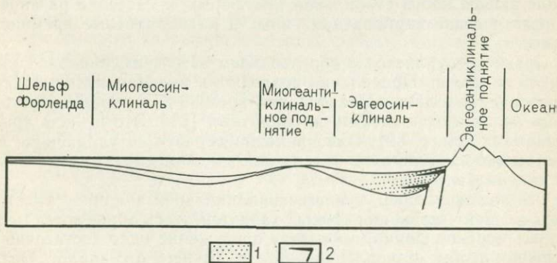
Фиг. 145. Схематический разрез геосинклинали с указанием различных структурных элементов. По Обуэну [2].
