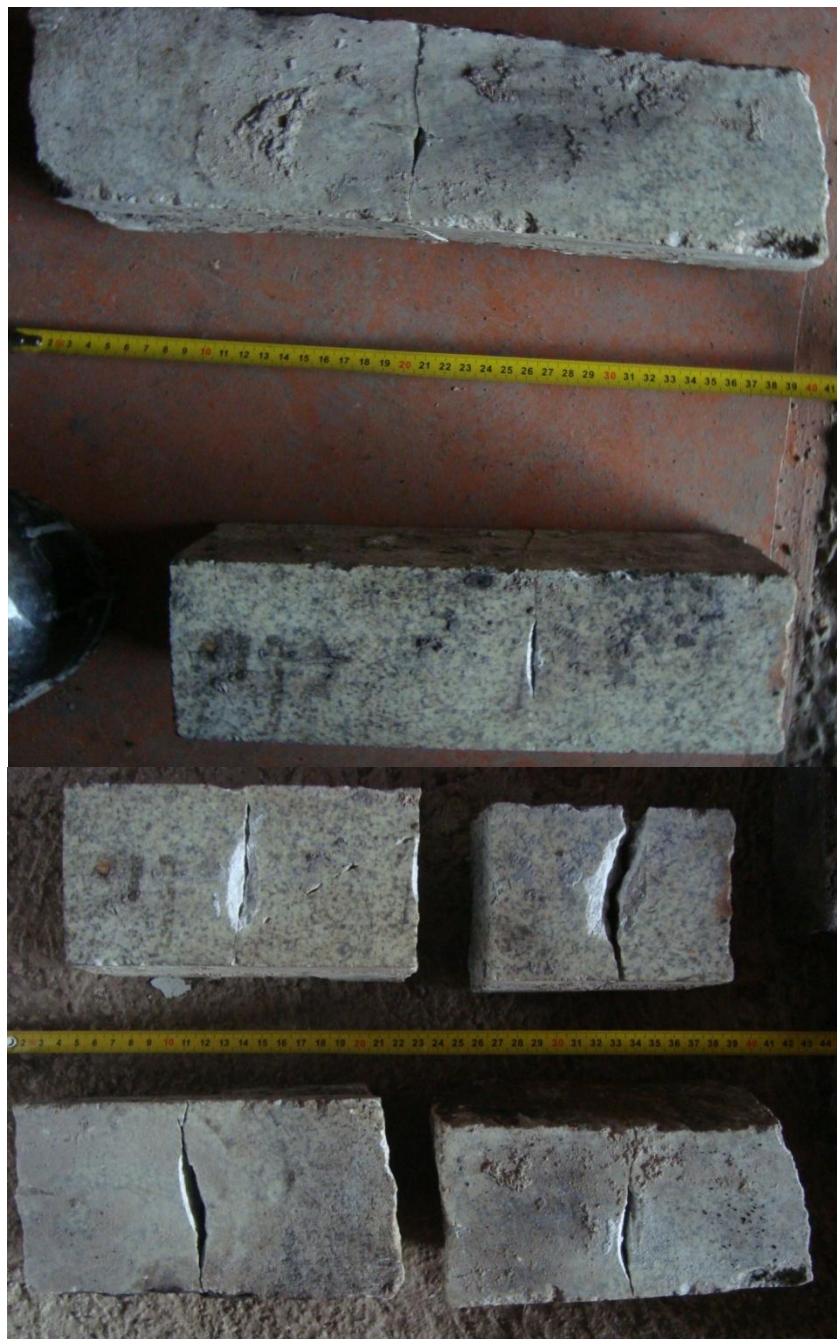
Рис. 4.6. Образцы гранита, разрушенные эллипсоидным инструментом с соотношением радиусов кривизны 3,5.
