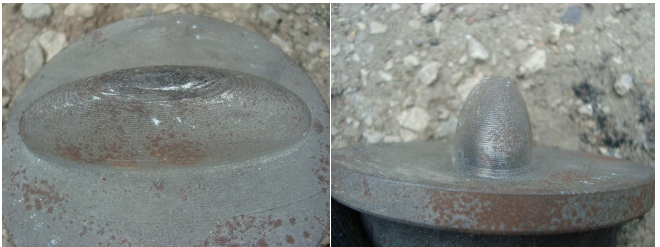
Рис. 4.2. Породоразрушающий инструмент эллиптической формы с соотношением радиусов кривизны, равным 3,5.
