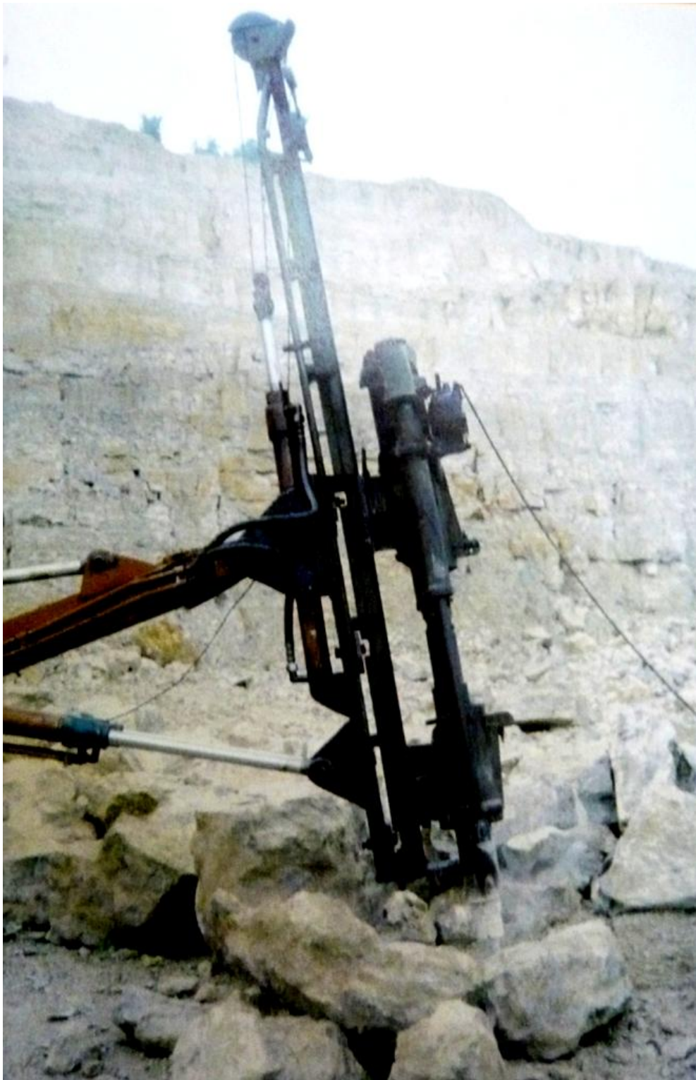
Рис. 1.3. Дизель-молот штанговый ДМ-150 при дроблении известняка
