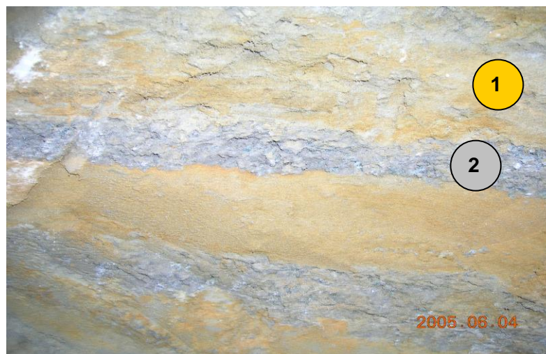
Рисунок 1.32 – Вертикальный разрез старогоднего хвостохранилища с чередующимися слоями буро-жёлтых (1) и серо-сизых (2) разностей
