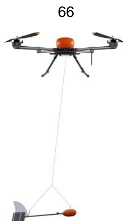
Рисунок 2.1 – Применяемый в исследованиях беспилотный летательный аппарат Геоскан-401 и квантовый магнитометр геоскан QM-Rb
