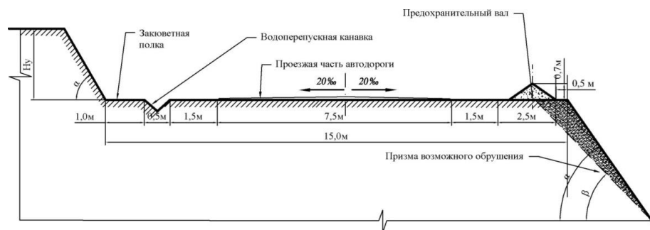
Рисунок 4.10 – Поперечный профиль транспортной бермы
