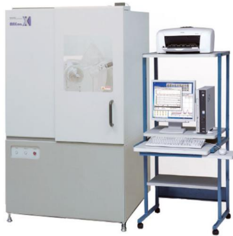
Рисунок 2.17 – Рентгеновский дифрактометр XRD 7000 («SHIMADZU») для определения фазового минерального состава техногенного золотосодержащего сырья
