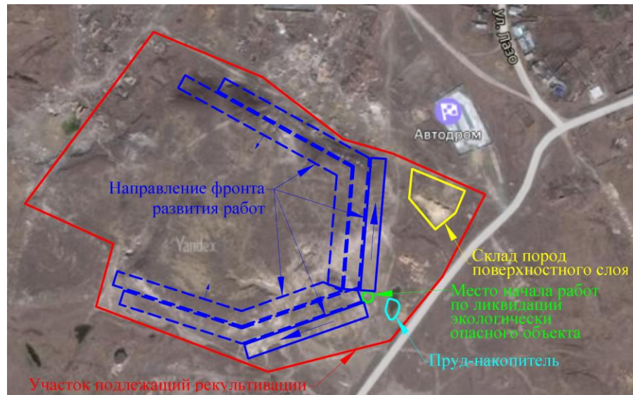
Рисунок 4.9 – Схема разработки Новотроицкого хвостохранилища, предусматривающая порядок и направление выемки техногенного золото-мышьяковистого сырья
