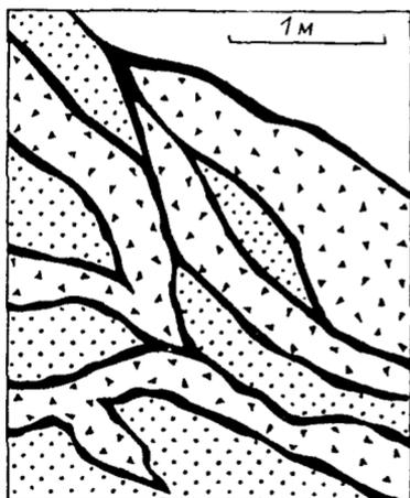
Рис. 46. Линзовидные зоны ТБ и ОПП в окаймлении шнуровидных МТБ. Обн. Ка-42, правый берег р. Кары несколько ниже устья р. Силоваяха; зона интенсивного дробления в кремнистой толще нижнего визе.
