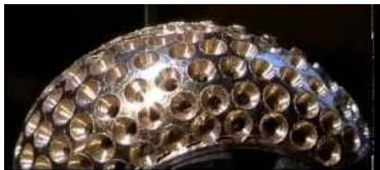
Рис. 68. Подготовленная поверхность кольца под закрепку «паве» [14]
