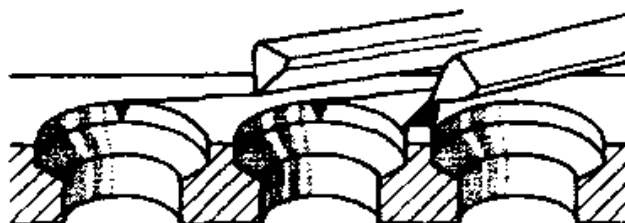
Рис. 59. Подрезка клиньев на двухкорнеровой оправке
