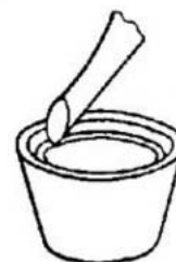
Рис. 15. Изготовление гнезда камня вырезанием опоры (юстированная оправа)
