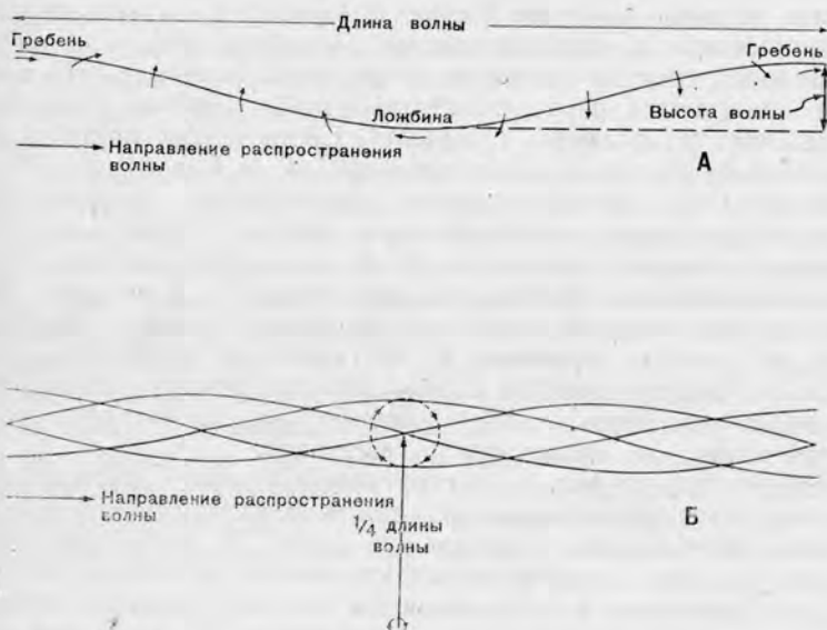
Фиг. 3. Показан характер движения воды в различных частях волн. Обратите внимание, что движение частиц воды на глубине, равной \frac{1}{4} длины волны, значительно затухает.
