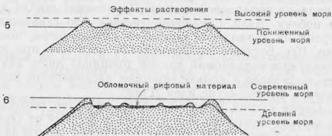
Фиг. 106. Развитие атолла в результате волновой абразии, последующего погружения, сопровождающегося ростом рифа, и растворения коралловых известняков во время низкого стояния уровня океана в ледниковое время.
