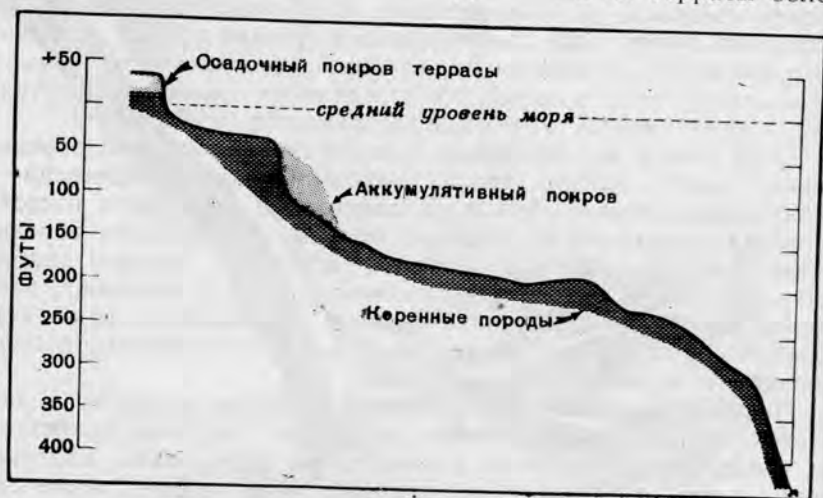
Фиг. 44. Затопленная и частично захороненная современными осадками абразионная терраса. Ее существование было установлено с помощью гидравлического бурения, выполненного водолазом. Соотношение вертикального и горизонтального масштабов примерно 1:10.
